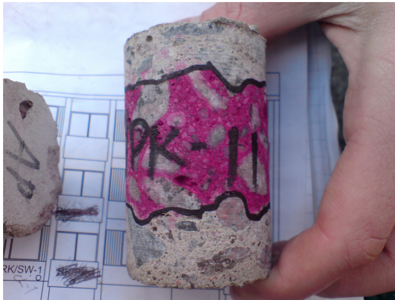
Kuva 3 Fenoliftaleiinilla käsitelty betonilieriö /3/
