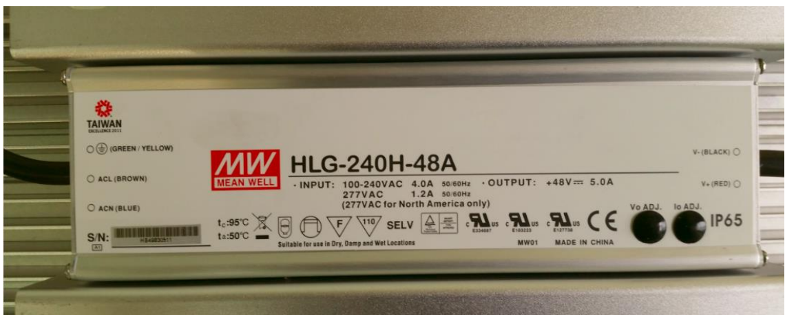
KUVA 5. Liitäntälaitte Mean Well HLG-240H-48A
