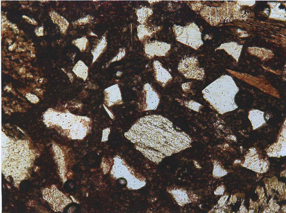
Kuva 3 (näyte AM/PP15). Parvekepielen betoni on tasalaatuista ja tiivistä. Runkoainekappaleiden sideainetartunnat ovat tiiviitä. Kuvan pidemmän sivun pituus on 1,6 mm.
