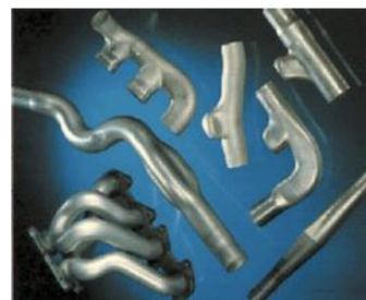
Kuvio 21. Hydromuovauksen etuja pakoputkien valmistuksessa (Pelimanni 2014, 32)
