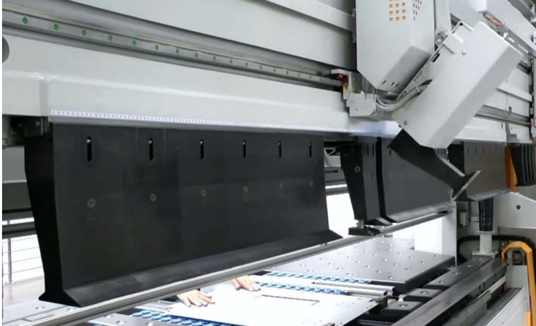
Kuvio 16. Robotti muuttaa pitimen leveyttä (RAS UpDownCenter)
