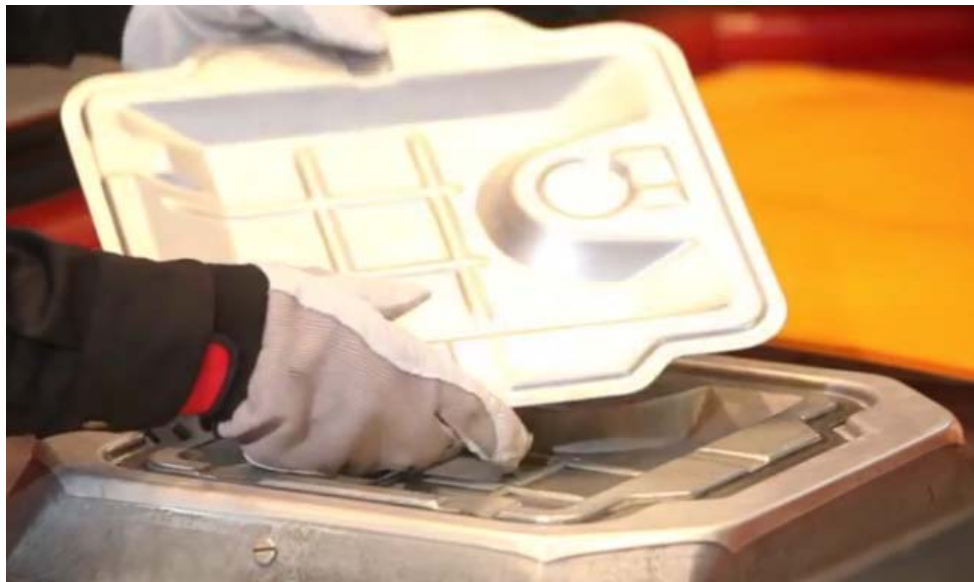
Kuvio 26. Terävällä muotinreunalla saadaan valmiiksi leikattuja tuotteita (Avure Fluid Cell Press)
