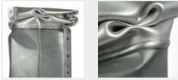
Kuvio 37. Törmäysenergiaa sitova rakenne (mt.)
