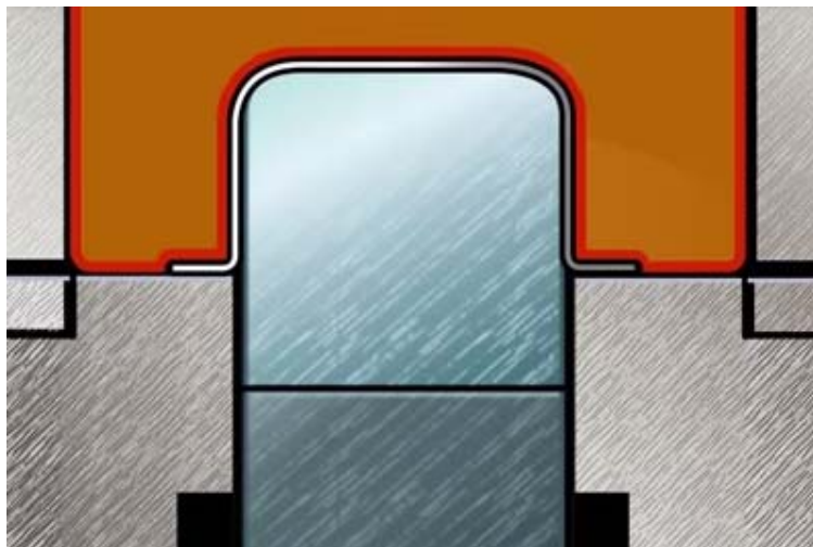
Kuvio 28. Deep draw hydroformingin periaate (Avure Deep Draw Hydroforming Principle)
