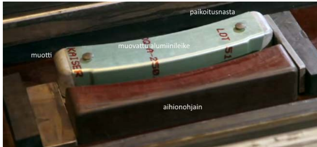
Kuvio 27. Yksinkertaisia flexform-työkaluja (Avure Technologies Sheet Metal Lab Forming Video 1)
