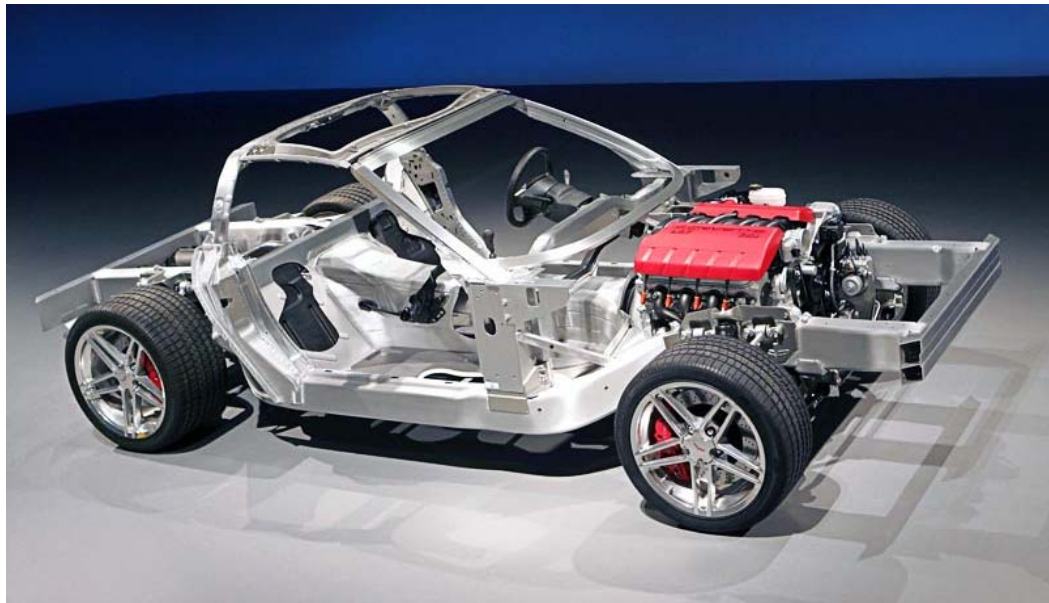
Kuvio 20. Auton runko, jossa on suurpainemuovautut alumiiniset runkopalkit (The Corvette Story)
