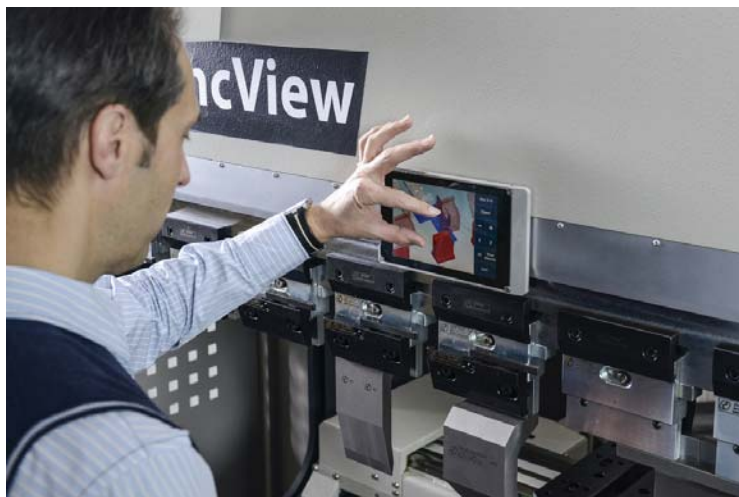
Kuvio 13. SyncView ohjeistaa käyttöä PRESSMASTER-särmäyspuristimessa (SyncView)
