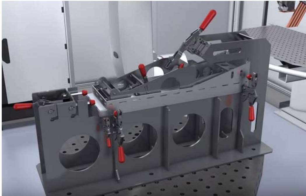
Kuvio 32. Tuotekohtainen jige (TRUMPF laser systems: TruLaser Robot 5020)
