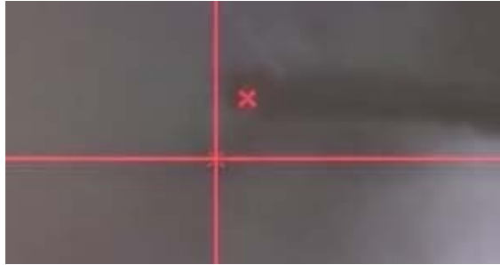
Kuvio 34. Referenssipisteen etsimistä kuvantunnistuksen avulla (FLW 4000 M3 Fiber Laser Welder)
