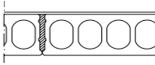
Kuva 5. Ontelolaattavälipohjan rakennetyyppi (kuva: Sini Vainio 2015).
