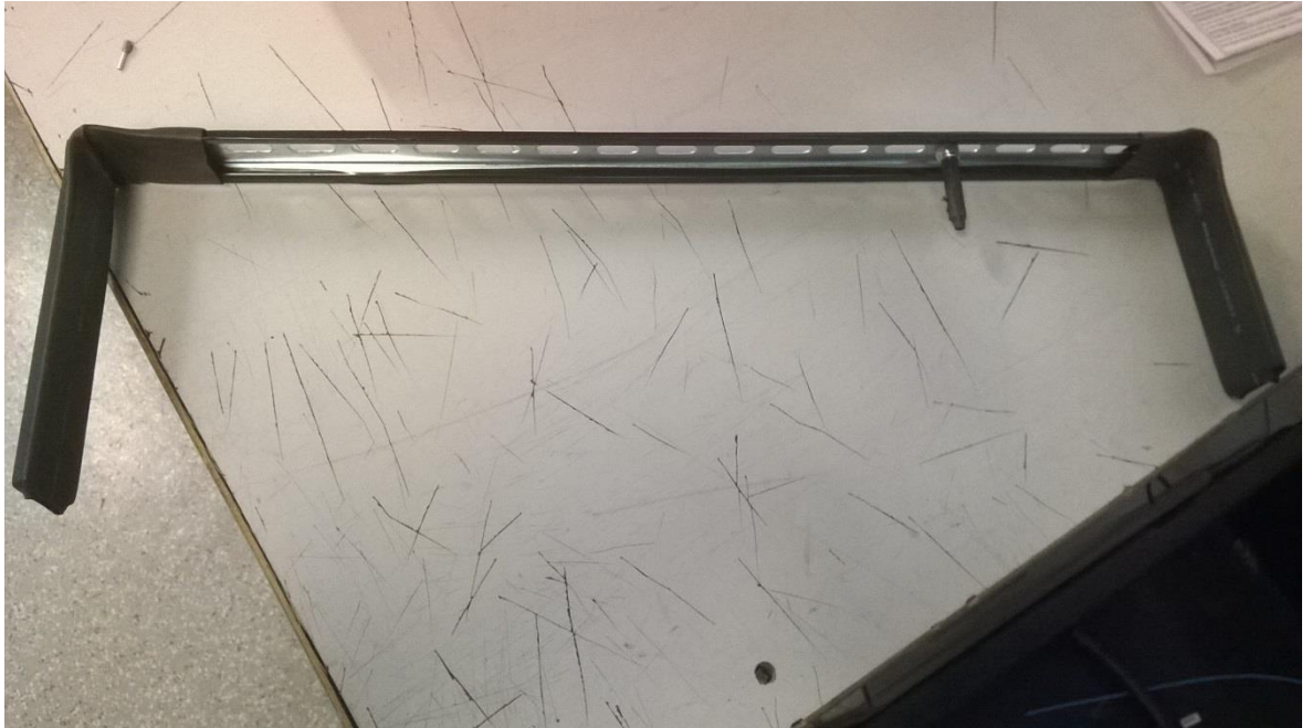
Kuva 1. Oven luukun tukirautaa.
