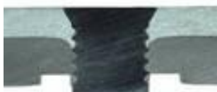
KUVA 20. SSPR-niittiliitoksen halkaisukuva (Tox® Pressotechnik 2015.)
