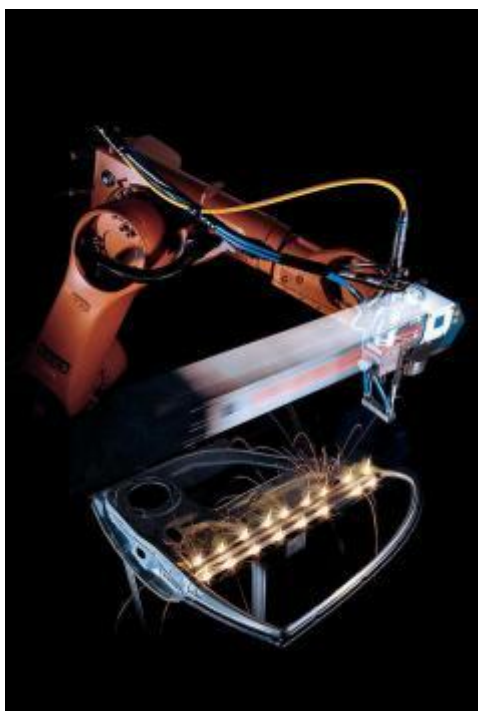
KUVA 12. RobScan-hitsausta auton oven sisäosiin (Apricon Oy 2012.)
