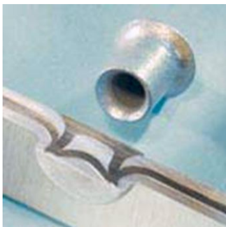
KUVA 18. Stanssiniitti ja valmiin liitoksen halkaisukuva (Coffey ja Strasser 2012.)
