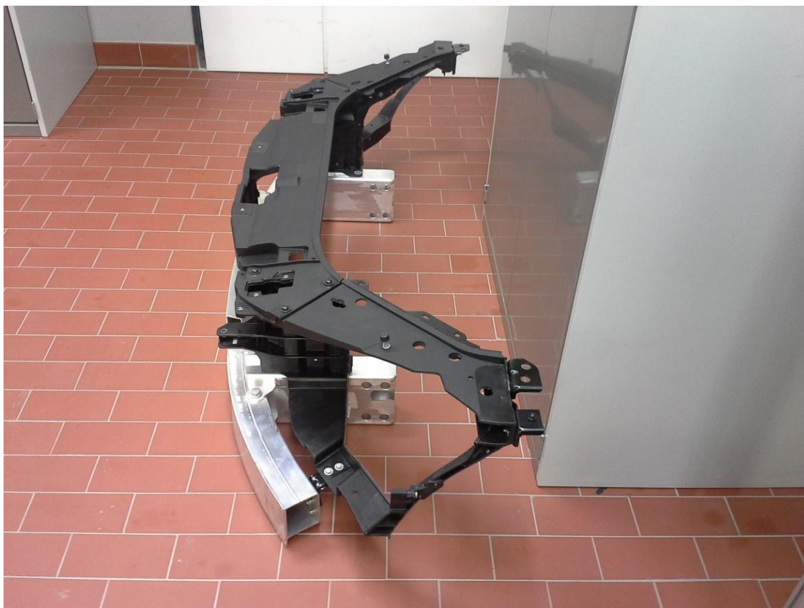
KUVA 11. W222-etupuskuripalkki, crash boxit ja lujitemuovinen etuosa (Kittelä 2013-9-24.)
