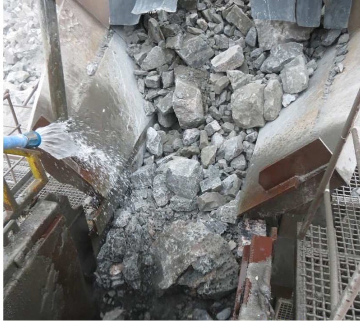
Kuva 3. Täräsyötin syöttämässä esimurskainta.
