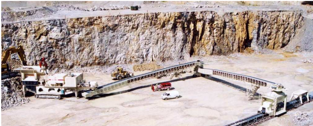
Kuva 11. Leukamurskain ja LokoLink-kuljetin yhdistettynä runkokuljettimeen (Metso Corporation 2011).
