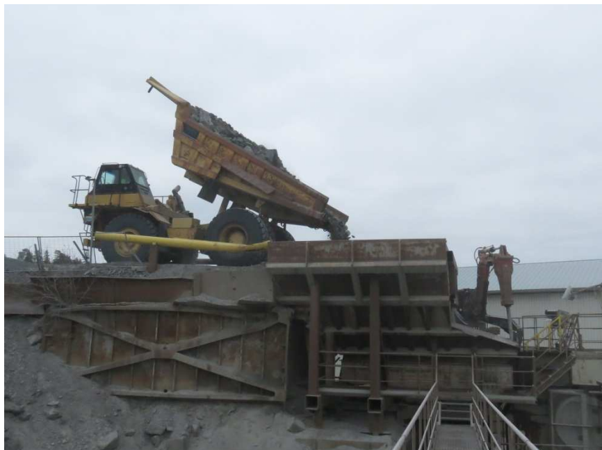
Kuva 9. Louheauto kippaamassa louhetta syöttimeen.
