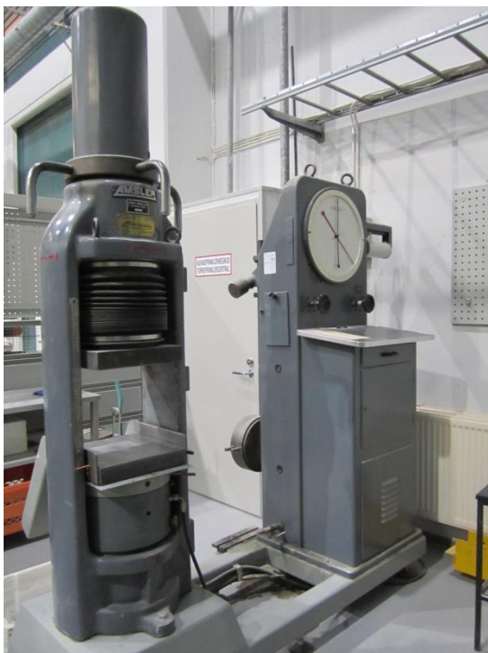
Figur 44. Hydraulpressen som användes vid alla provtrycknings tillfällen (Ralf Wasberg)
