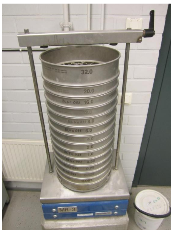
Figur 29. Siktmåtten med ballast placerade på vibratorapparaten (Ralf Wasberg)
