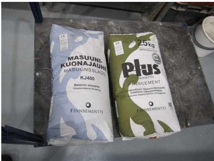
Figur 30. Masugnsslagg samt cement som användes i laborationerna (Ralf Wasberg)
