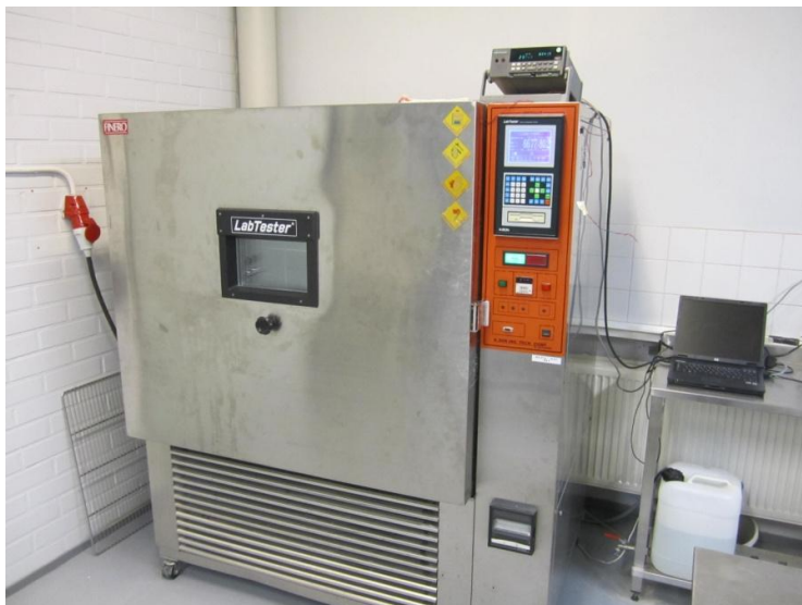
Figur 41. Temperaturlogger utrustning med inkopplad bärbar dator kan noteras till höger om klimatskåpet (Ralf Wasberg)
