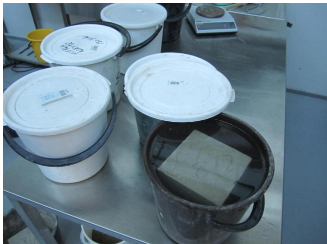
Figur 39. Vattenfyllda ämbar med kuber som är färdiga för mognad i klimatskåp (Ralf Wasberg)
