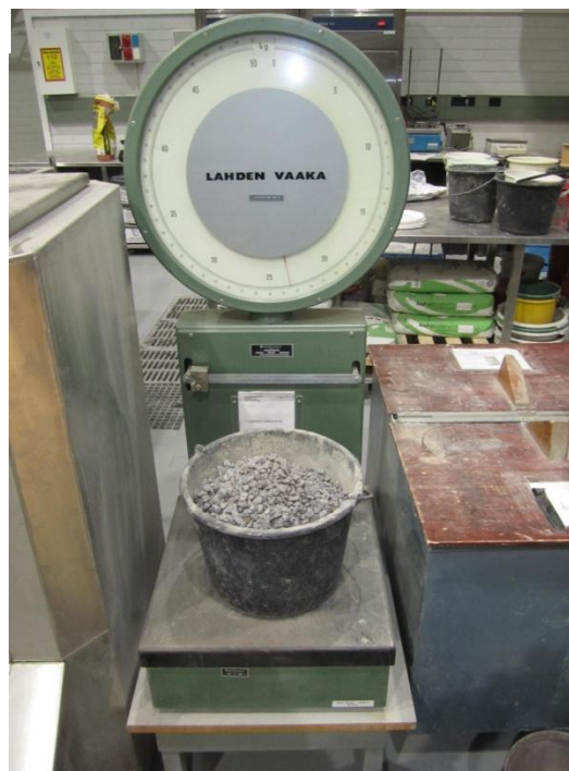
Figur 32. Vågen som användes för proportionering av ballast (Ralf Wasberg)
