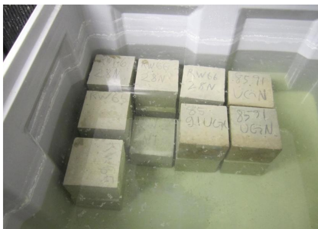
Figur 38. Lagring av kuber i 20°C normvattenbad (Ralf Wasberg)
