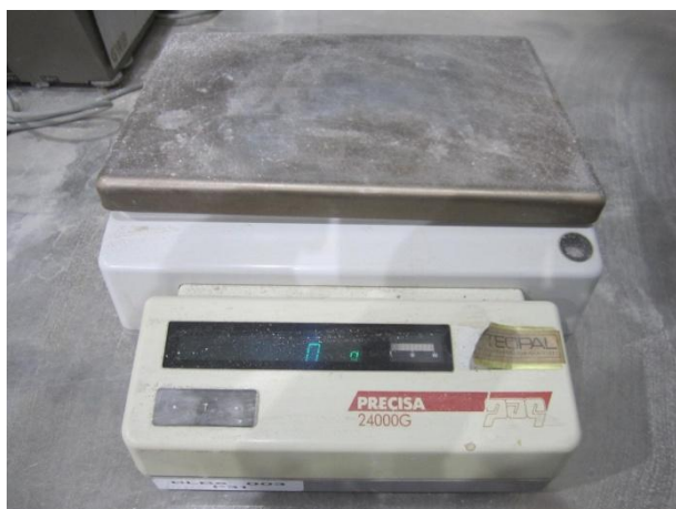
Figur 31. Vågen som användes för proportionering av slagg och cement (Ralf Wasberg)
