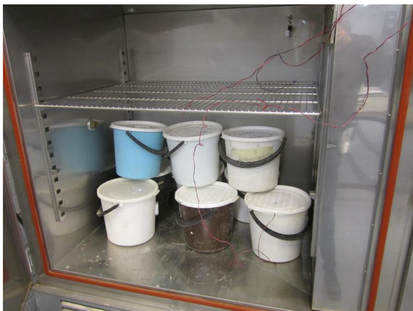
Figur 40. Klimatskåpet med ugnskuber, här kan givarnas placering noteras (Ralf Wasberg)
