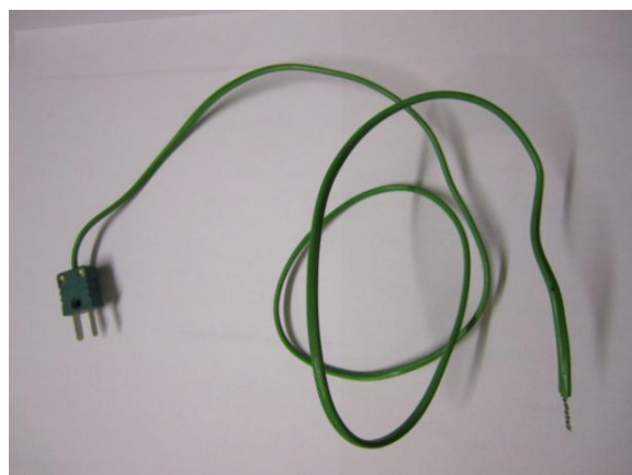
Figur 22. Till dataloggern kopplas en termoelementkabel som fungerar som givare(Ralf Wasberg)
