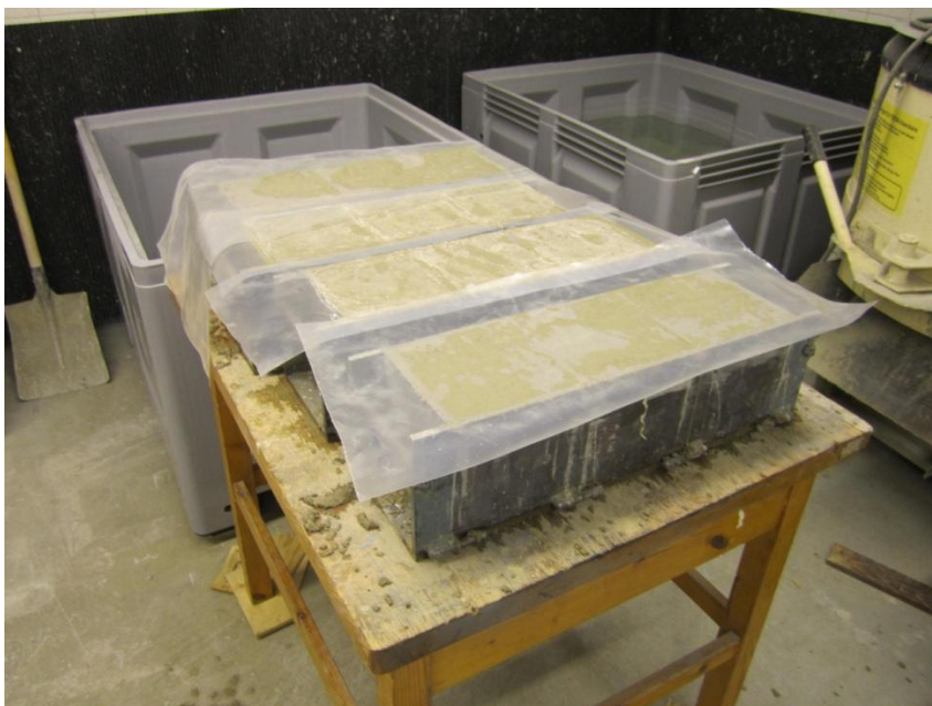
Figur 37. Formorna ställdes på plant underlag för att undvika större måttavvikelser (Ralf Wasberg)
