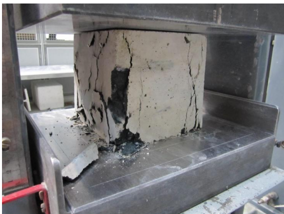
Figur 45. Kuberna skall tryckas centriskt enligt de frästa märkena i tryckningsbordet (Ralf Wasberg)
