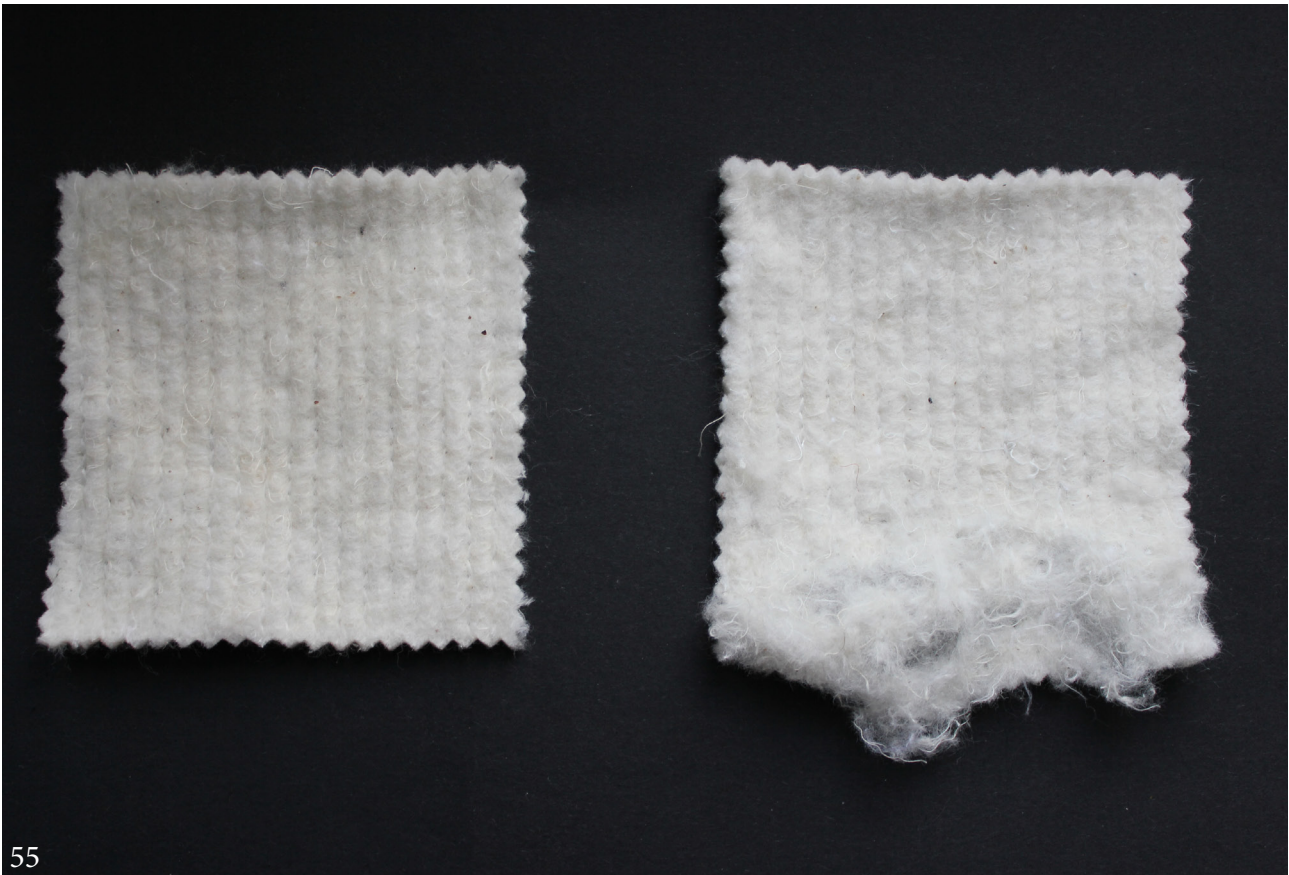
Kuvio 55: Teokseen käytetty alin materiaali sekä sen purkautuminen kuiduksi. Materiaalitiedot: BELL-verho/ pöytähuopa. Koostumus: 76% puuvilla, 21% viskoosi, 3% polyamidi
