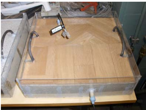
Kuva 5 Koekappale 3. Koekappale on pinnoitettu kuivantilan joustovinyylimatolla, joka on liimattu betoniin mattoliimalla
