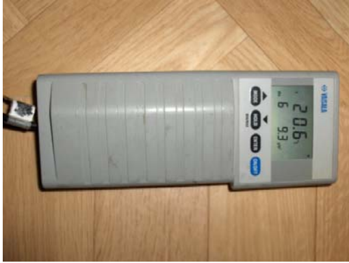
Kuva 8 Mittalaitteina käytettiin Vaisala HMI 41 näyttölaitetta ja Vaisala HMP 44 antureita.
