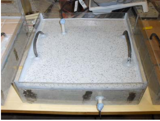
Kuva 3 Koekappale 2. Koekappale on päällystetty kostean tilan muovimatolla, joka on liimattu betonilaattaan mattoliimalla.
