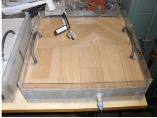
Kuva 6 Koekappale 3. Koekappale on pinnoitettu kuivantilan joustovinyylimatolla, joka on liimattu betoniin mattoliimalla
