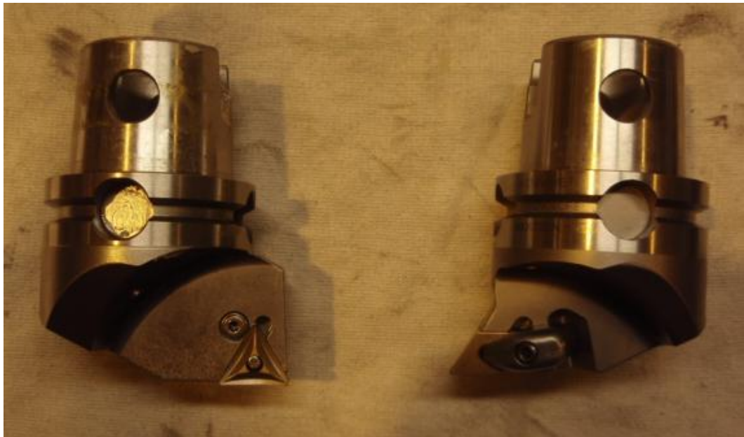
KUVIO 13 Okuma S-837 sorvaustyökalut, vasen viimeistelyyn käytettävä kolmiopala ja oikea rouhintaan käytettävä veitsiterä
