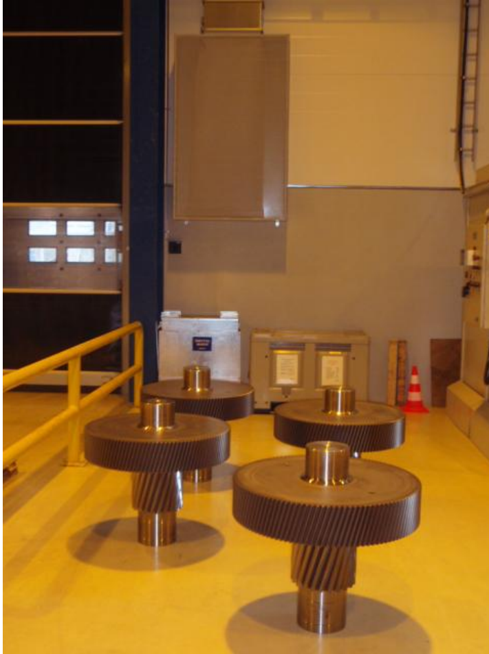
KUVIO 19. PIH-1400 väliakseleita koottuna jäähtymässä ilmastoinnin raittiin ilman tulopuolen sekoittimen edessä.
