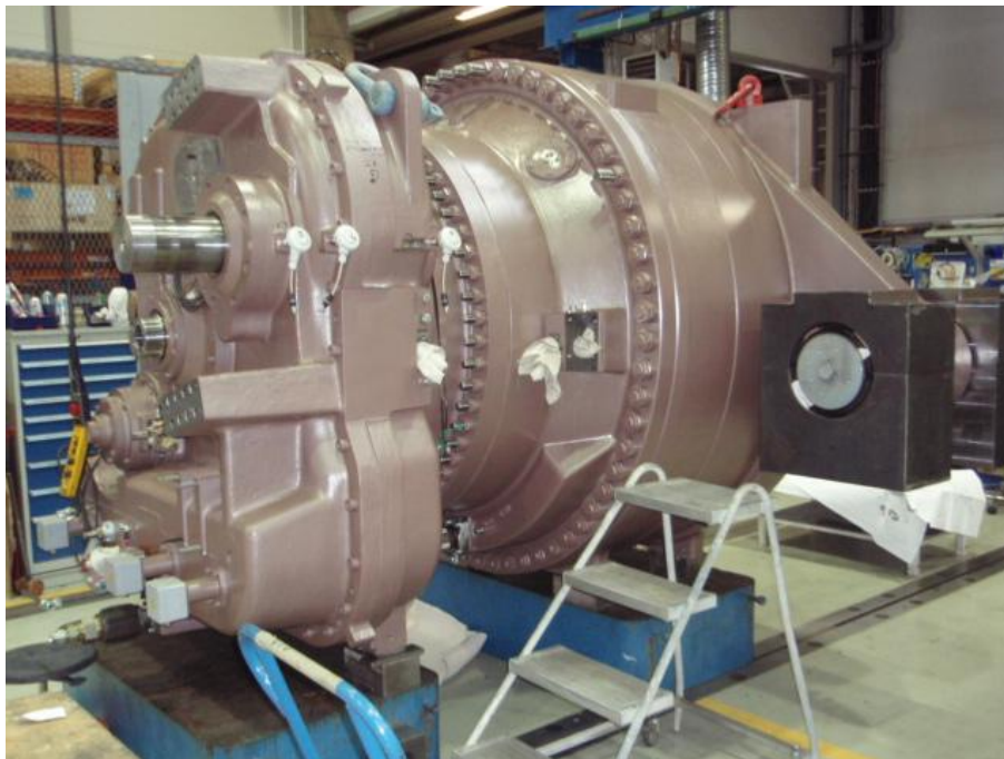
KUVIO 2. 3000-KW tuuliturbiinivaihte kasattuna ja valmiina koekäyttöön. Koekäytön jälkeen vaihteisto maalataan ja loppu varustellaan
