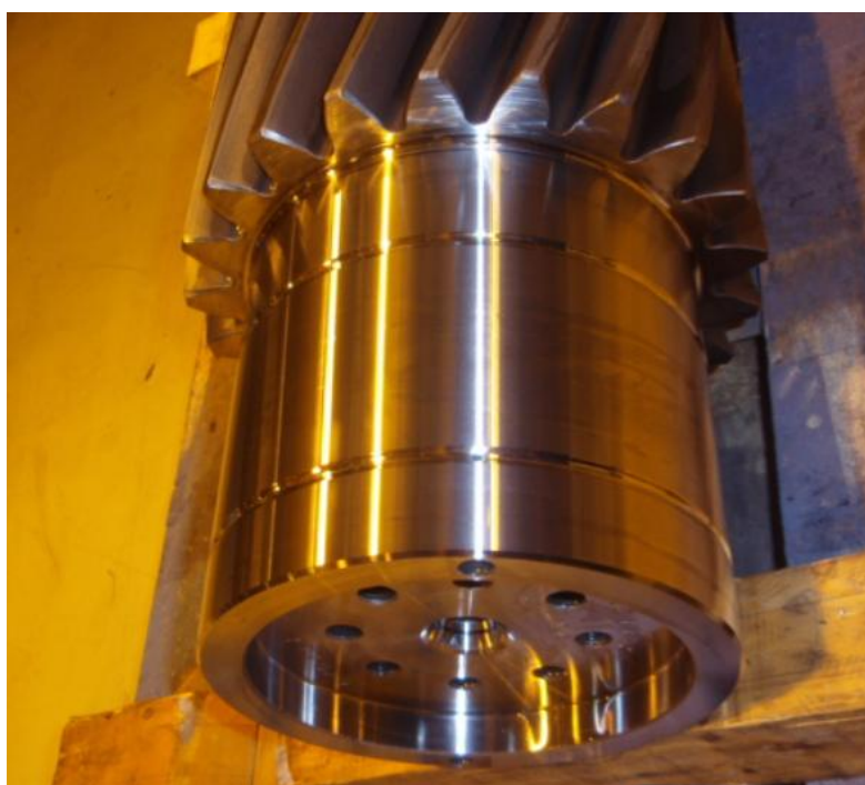
KUVIO 12. Pih-1400 Väliakselin päässä oleva potero ja kierrereikäpiiri josta otetaan veto akselin pyörittämiseen pyöröhionnassa
