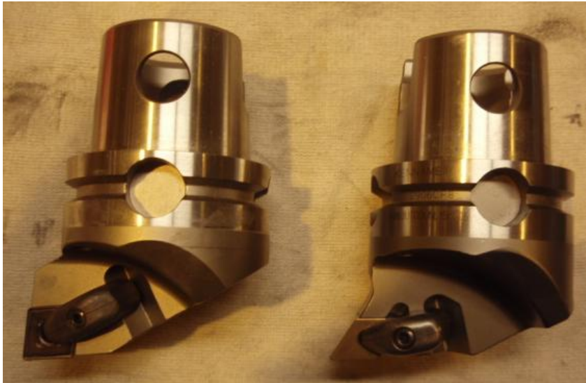
KUVIO 16. Okuma S-837 valitut uudet teräpitimet. Vasemmalla rouhintäterä ja oikealla viimeistelyterä
