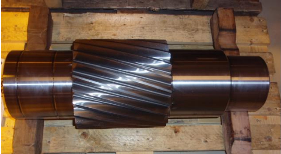
KUVIO 5. Kaikki väliakselin jalostavat työvaiheet läpikäynyt väliakseli PLH-1700
