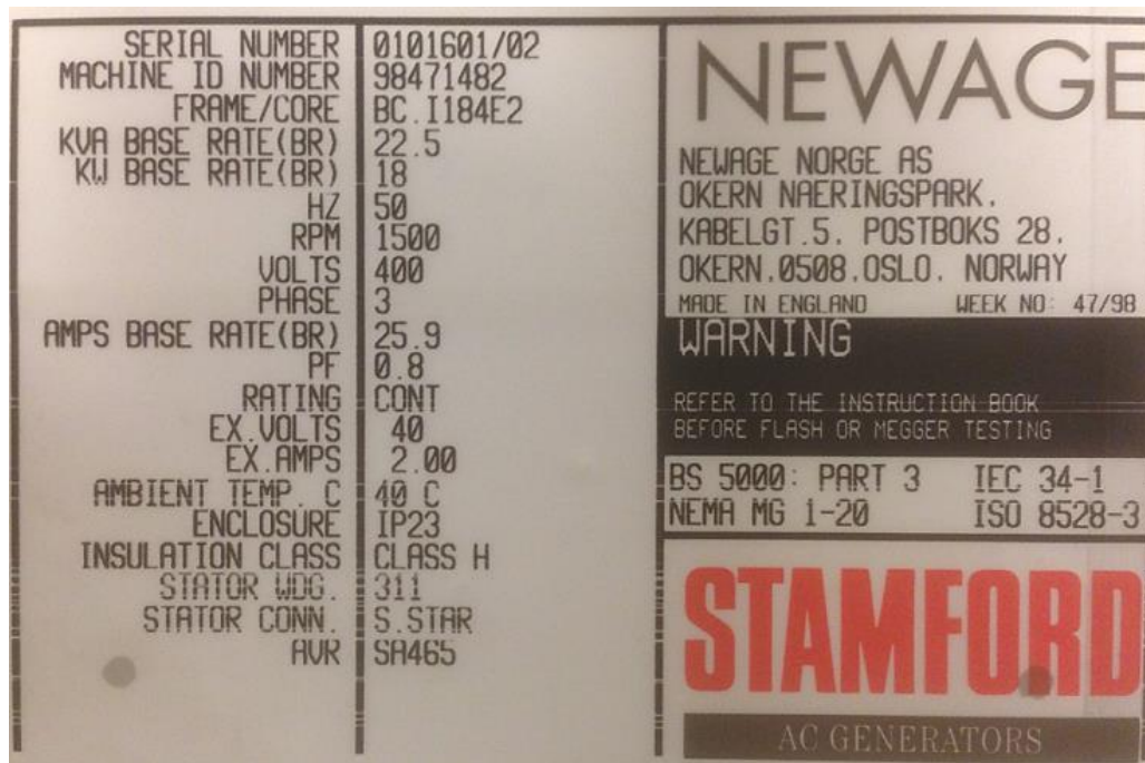
KUVA 14. Stamfordin BC184 E2 -tahtigeneraattorin kilpiarvot
