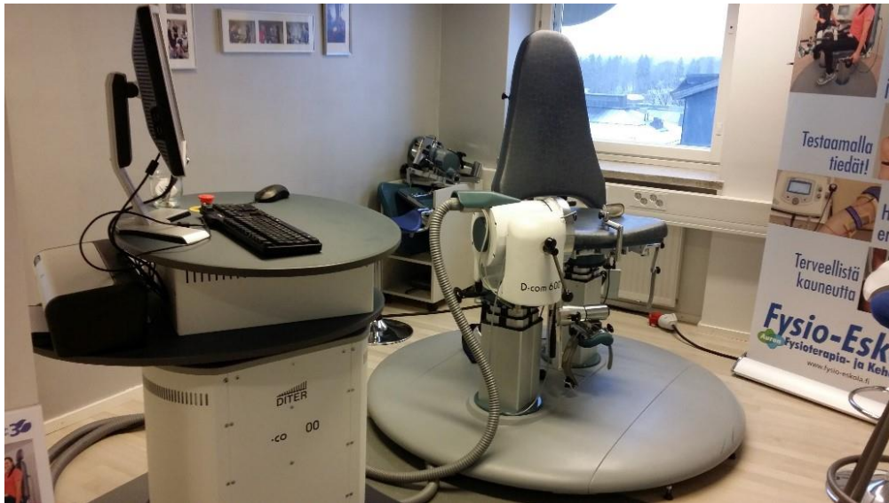
Kuva 8. Isokineettinen dynamometri Diter D-com 650. (Maria Heikkinen)
