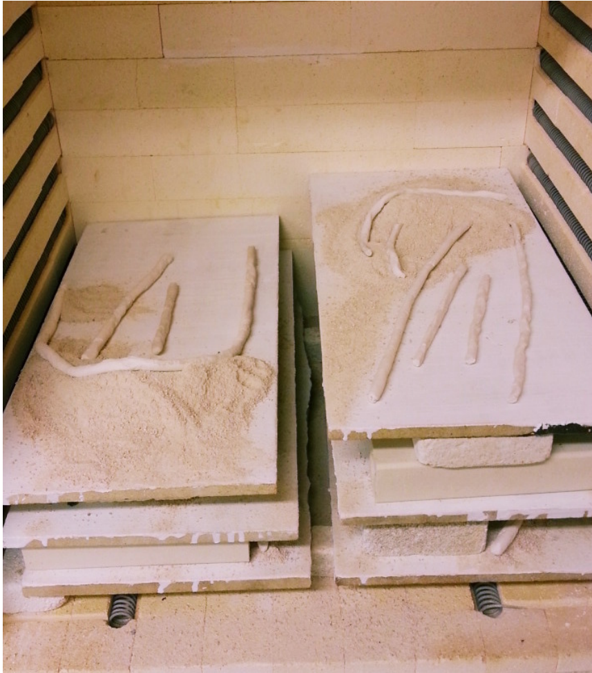
Bild 21, inför bränning av porslinet som vilar på kullar av schamott
