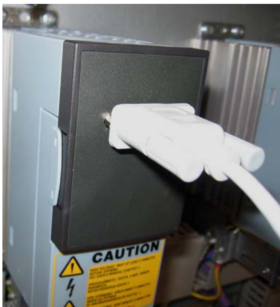
Kuva 24 Adapteri, taajuusmuuttajan liittämiseksi tietokoneeseen
