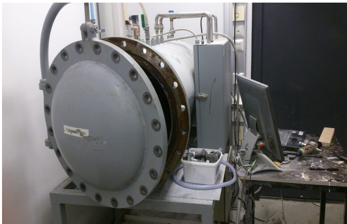
Kuva 10. Delaminointikokeessa käytetty painesäiliö. Kuva Ville Räsänen 2015
