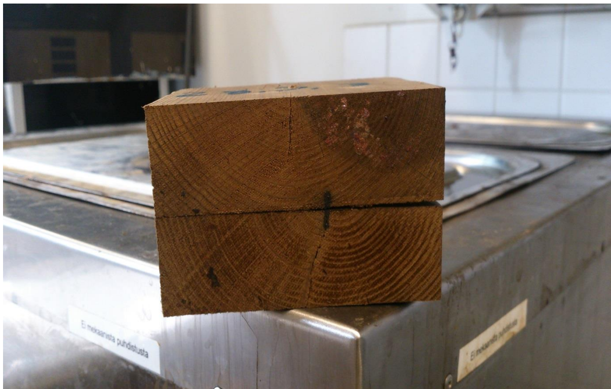
Kuva 13. Esimerkki liimasauman aukeamisesta. Kuva Ville Räsänen 2015
