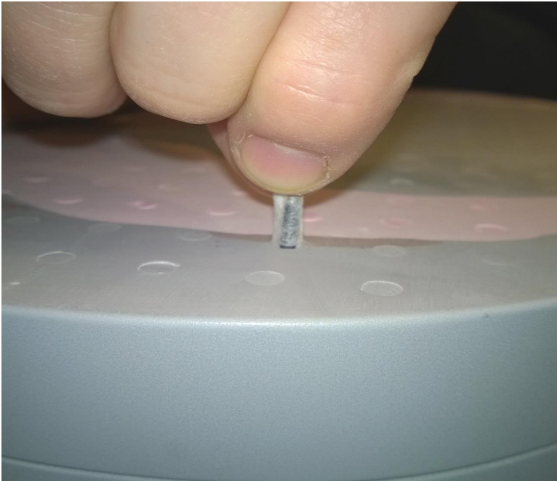
KUVIO 2. MOSFET -anturin asettaminen fantomin reikään Mittausjärjestelmä ja antropomorfinen fantomi on OYS kuvantamisella validoitu elinannosmittauksiin. ”TN-1002RD MOSFET soveltuu riittävän hyvin mittaamaan absorboituneita ja efektiivisiä annoksia” (Kotiaho ym. viitattu 28.4.2014) (kuva Joni Granlund)
