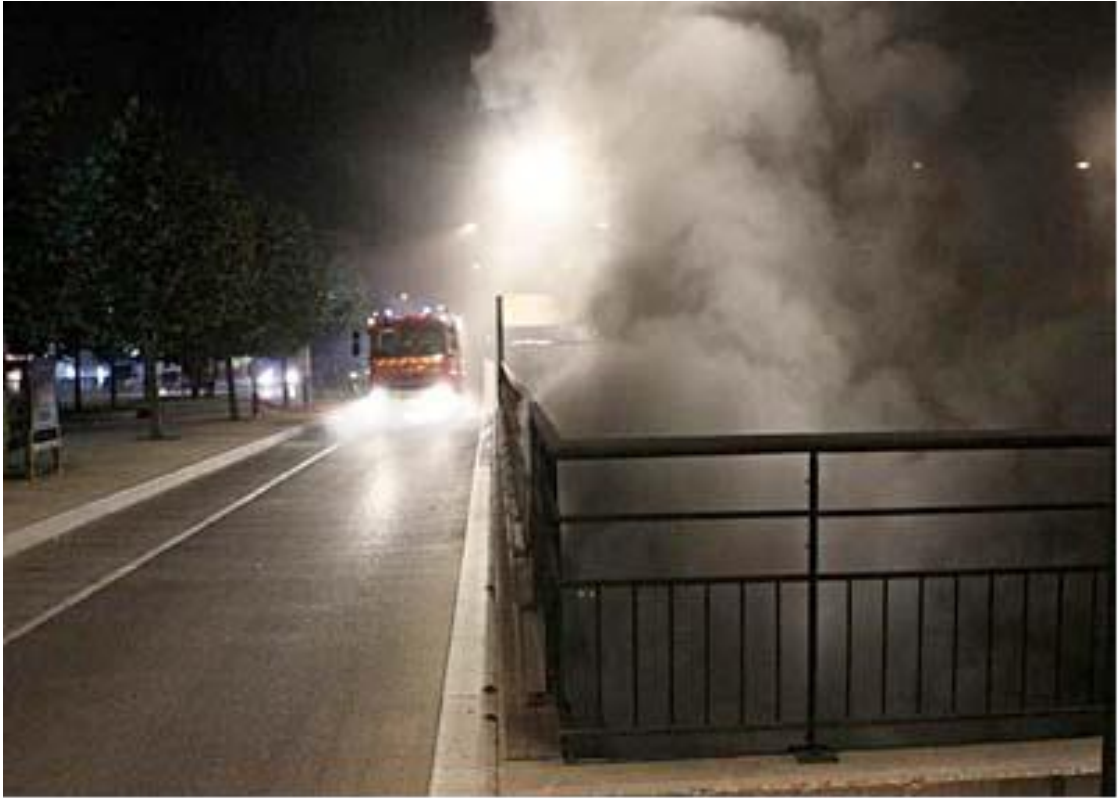
Kuva 2. Kuuman savukaasun purkautuminen kulkureitin kautta (Via Le Dauphine, 2011).
