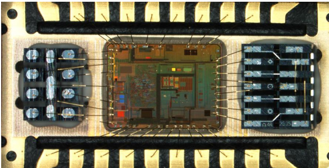
Kuva 2. SCC2000-tuoteperheen komponentti, jonka sisällä on kiihtyvyyssanturielementti kuvassa vasemmalla. ASIC-piiri on kuvassa keskellä ja gyroanturielementti on kuvassa oikealla.
