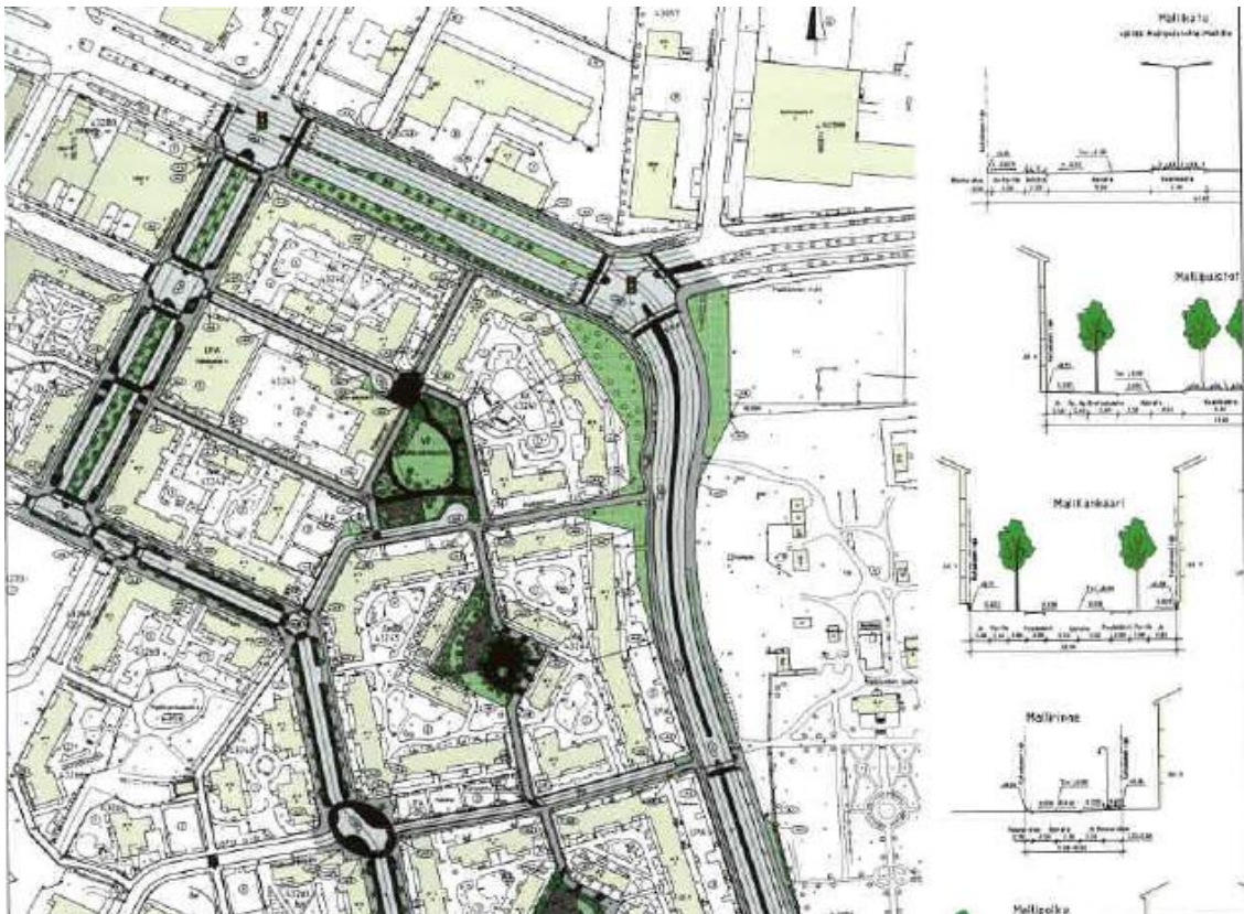
KUVA 9. Katusuunnitelman asemapiirros ja tyyppipoikkileikkauksia (Katu ympäristön suunnitteluopas 2011, 27.)
