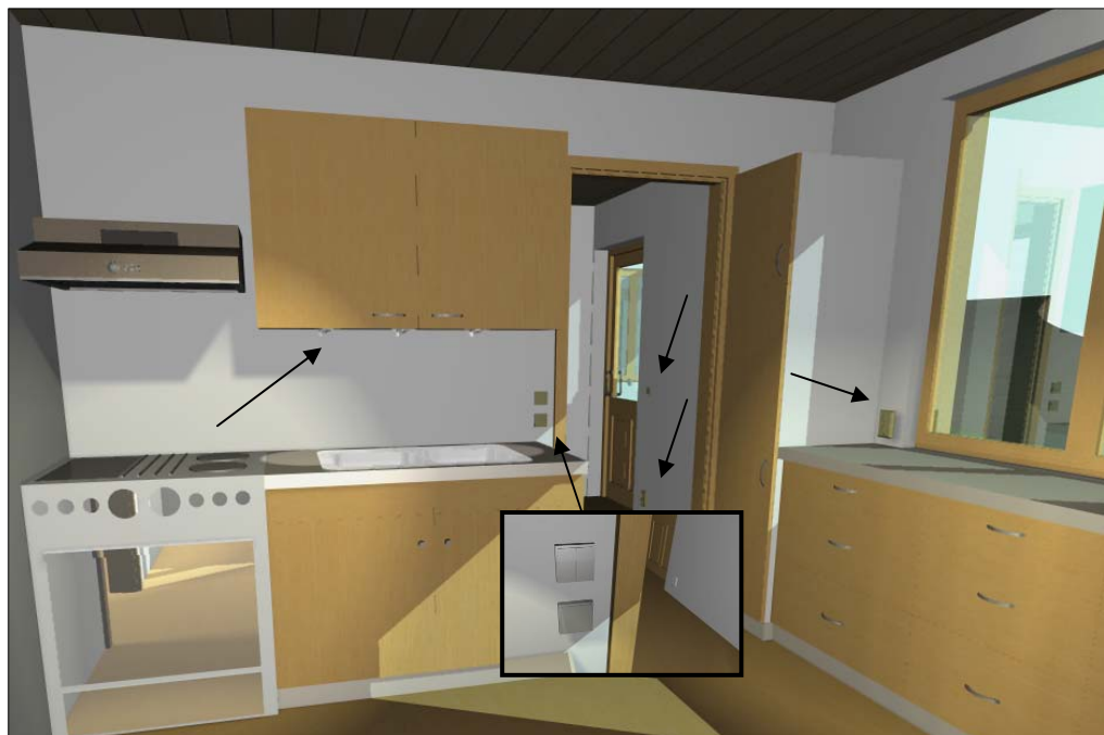
Kuva 18 Asiakkaalle ArchiCADillä tehty keittiön mallikuva, jossa sähköpisteet tuotu IFC -tiedostosta (nuolilla korostettu).
