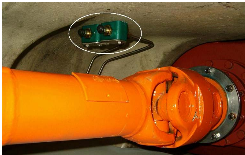
Kuva 17. Käsijarru- ja käyttöjarrulinjan ilmausruuvit.
