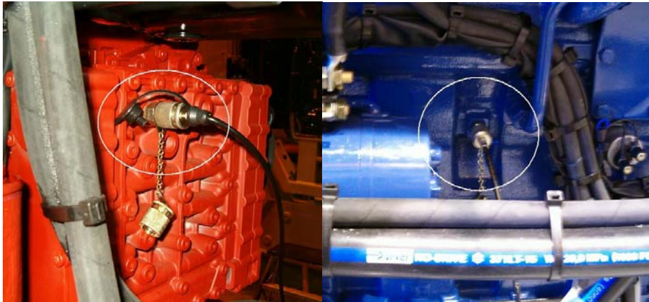
Kuva 15. Vaihteiston ja moottorin öljynpaineen mittapisteet.
