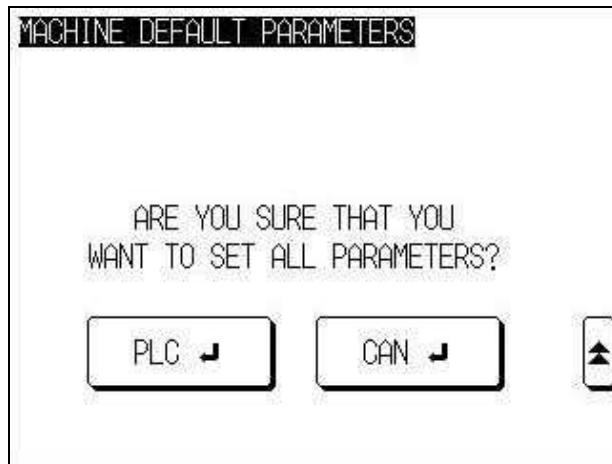
Kuva 12. Perusparametrien asetus PLC:hen ja CAN A100 -yksikköön.
