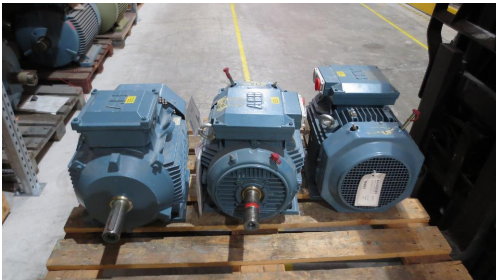
Kuva 7. Kestovoidelluilla laakereilla oleva kone kuvassa vasemmalla, kaksi muuta konetta ovat voideltavilla laakereilla.
