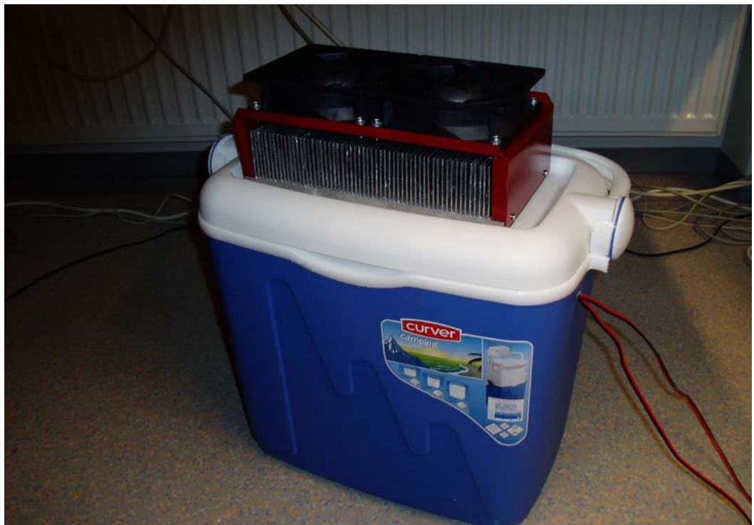
KUVA 14. Peltier-elementti asennettuna kylmälaukuun.
