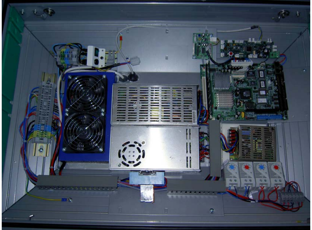
KUVA 12. Peltier-elementti asennettuna näyttöön
