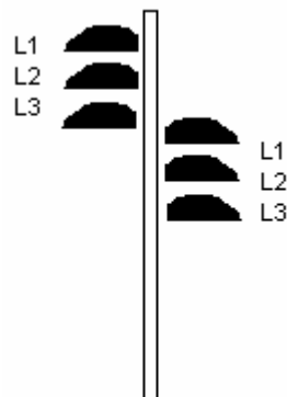
Kuva 2 Valonheitinvalaisimen lamppujen vaiheistus
