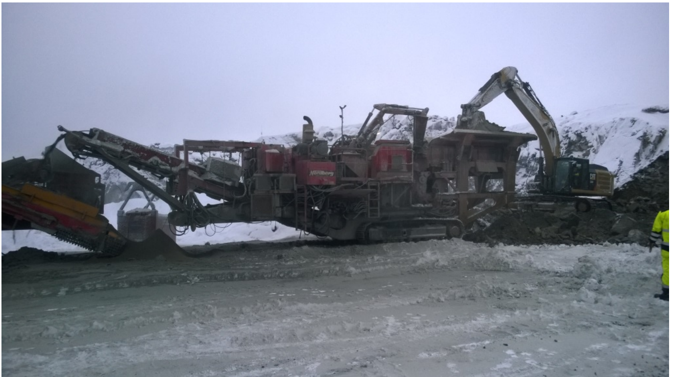
Kuva 9 Kaivinkone syöttää track-tyyppistä esimurskainta.
