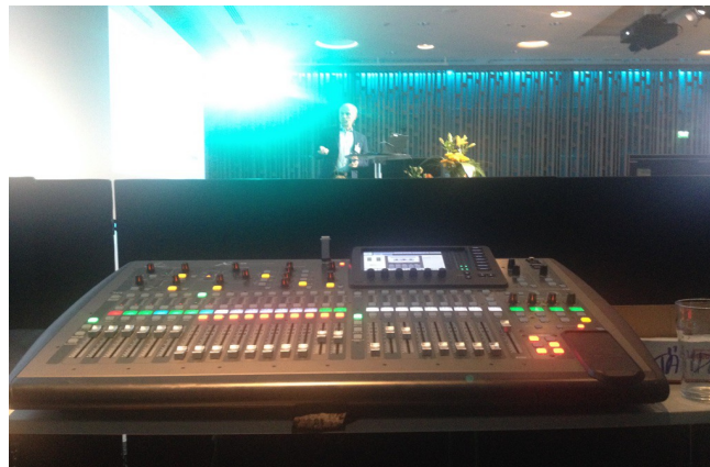
Kuva 8. Mikseri on äänimiehen tärkeimpiä työkaluja. Kuvassa Behringerin valmistama 32 kanavainen X32-äänipöytä. Kuva: Hänninen 2015.
