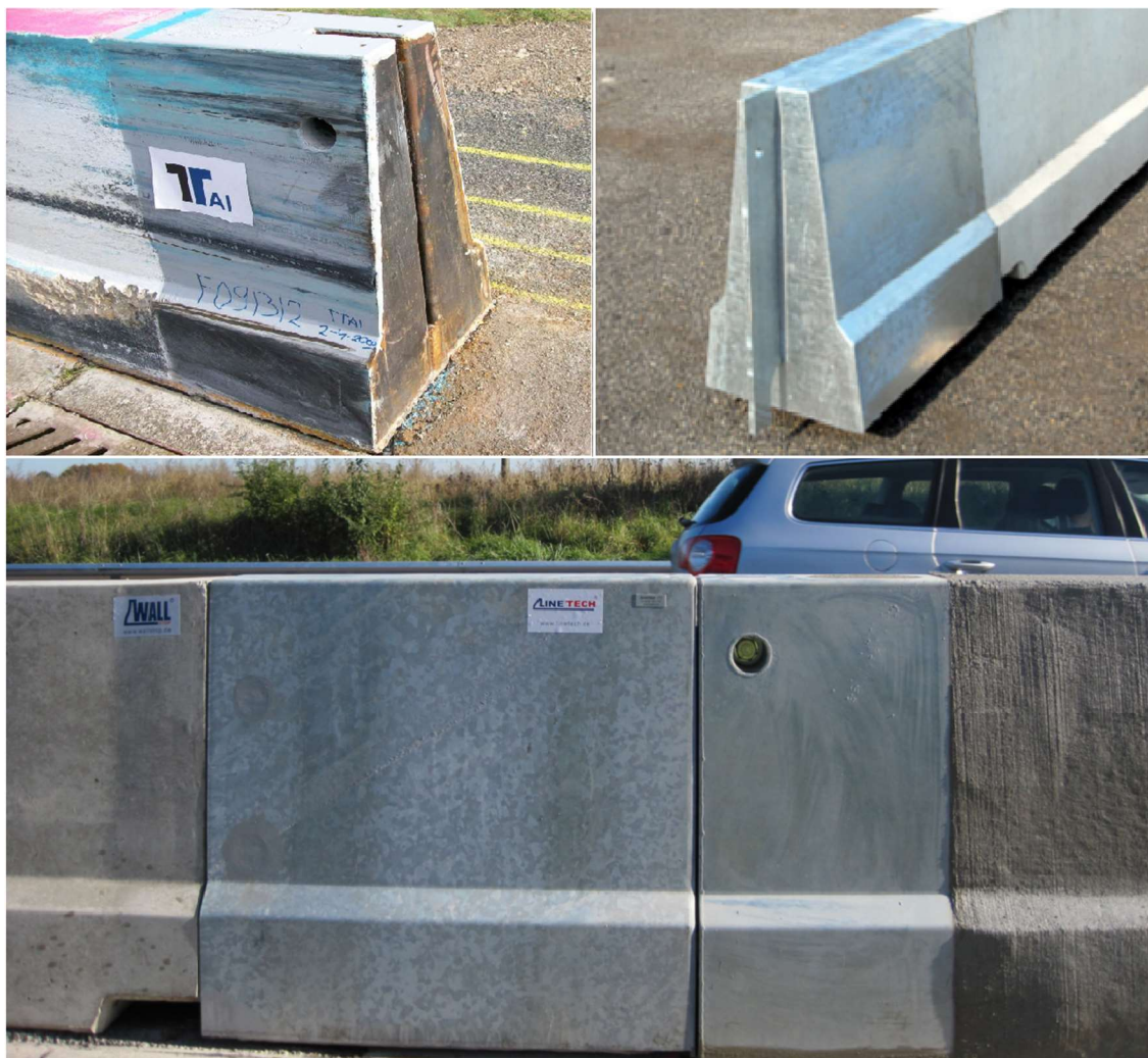
Kuva 23. H2 testattu liitos liukuvalukaiteen ja elementtikaiteen välillä (3.)
