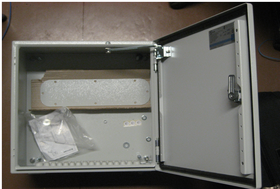
Kuva 1. Sääsuojakotelo, johon ohjausyksikkö asennetaan. IP-luokka 54, valmistajana Rittal.
