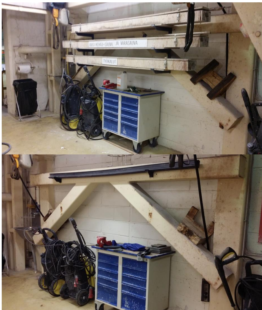
Kuva 6. Päälystysaseman säilytystila ennen ja jälkeen 5S-menetelmän
