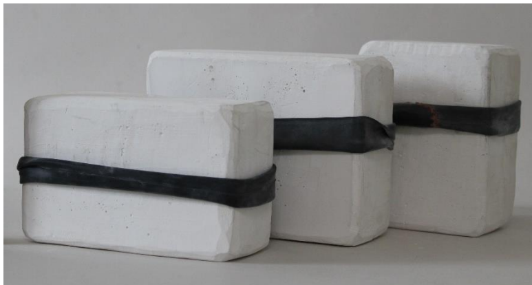
Kuva 44. Valmiit muotit kumilenkillä sidottuina
