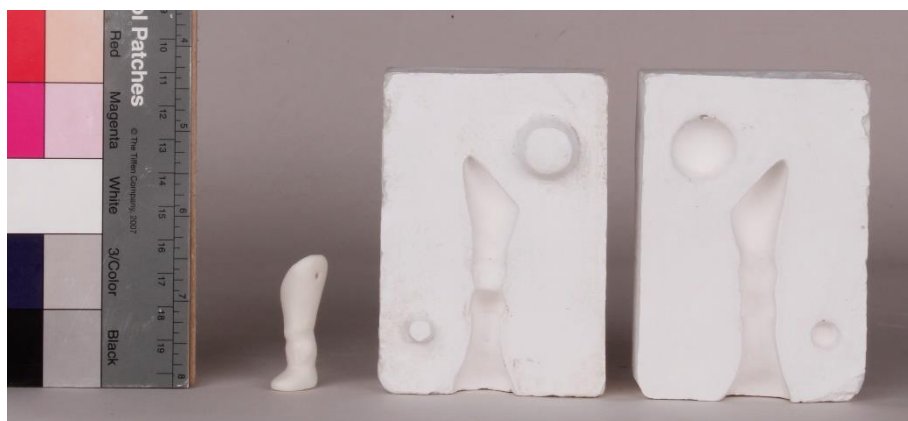
Kuva 36. Poltettu testijalka ja -muotti
