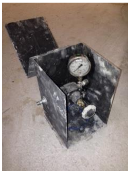
Kuva 12. Paineensäätimellä saadaan massauspallolle oikeanlainen paine.
