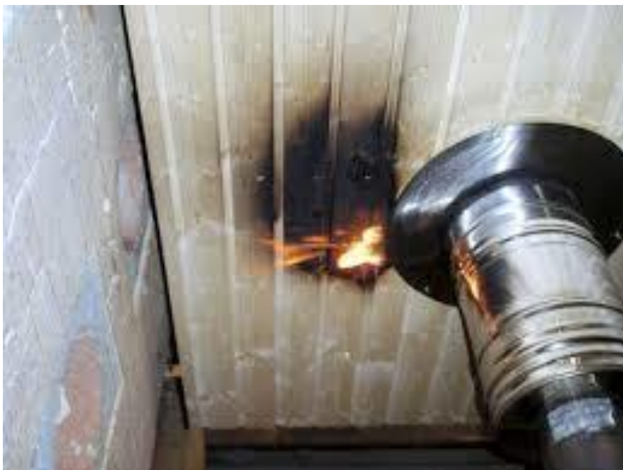
Kuva 4 Palon syttyminen läpiviennin kohdalta. [14]
