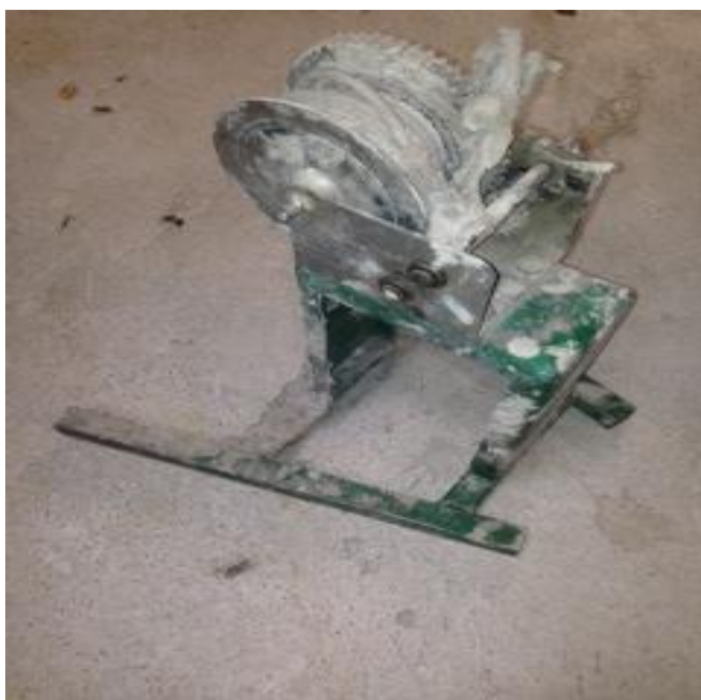
Kuva 12. Horminkorjaus vinssi, jolla vedetään massaharja tai palloa hormin alapäästä ylös.
