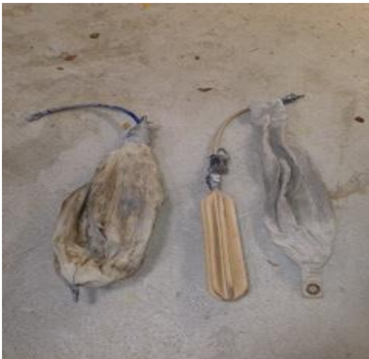
Kuva 14. Keskimäinen osa on ilmalla täyttyvä pallo ja vieressä on suoja kangaspussit, jotka levittävät massan hormin seinämille.
