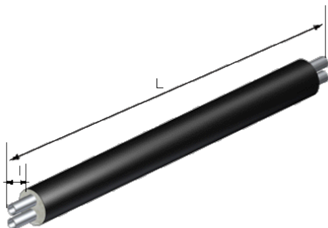
Kuva 13. Kaksiputkijärjestelmällä toteutettu kaukolämpöelementti [16].
