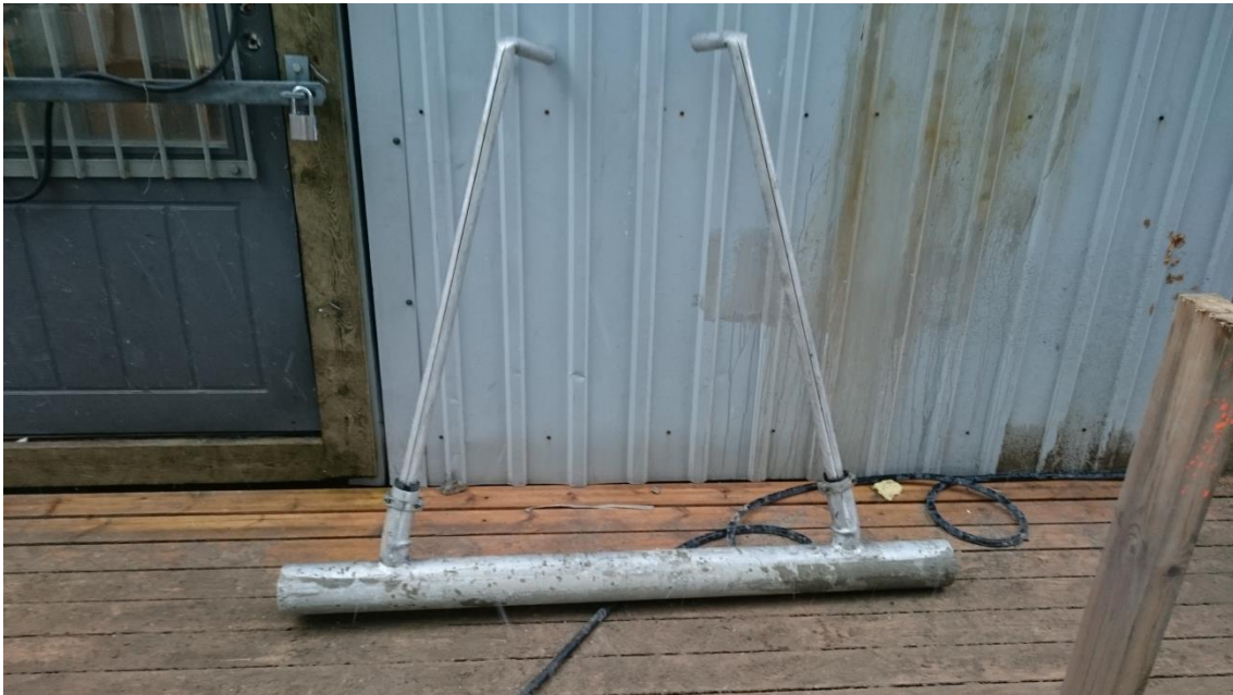
KUVA 6. HT-lattiabetonin tasoittamiseen tarkoitettu hyssytin
