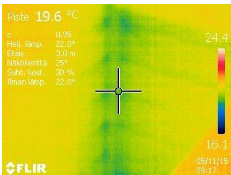
Kuvio 15. Saunan seinäpaneelit lauteiden alla. TI 94 %, korjausluokka 4, paneelissa silmännähtävä mikrobivaurio, joka laskee korjausluokan 1.
