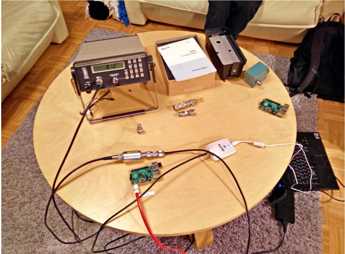
Kuva 3. Lähetytshon mittaus Marconin tehomittarilla.
