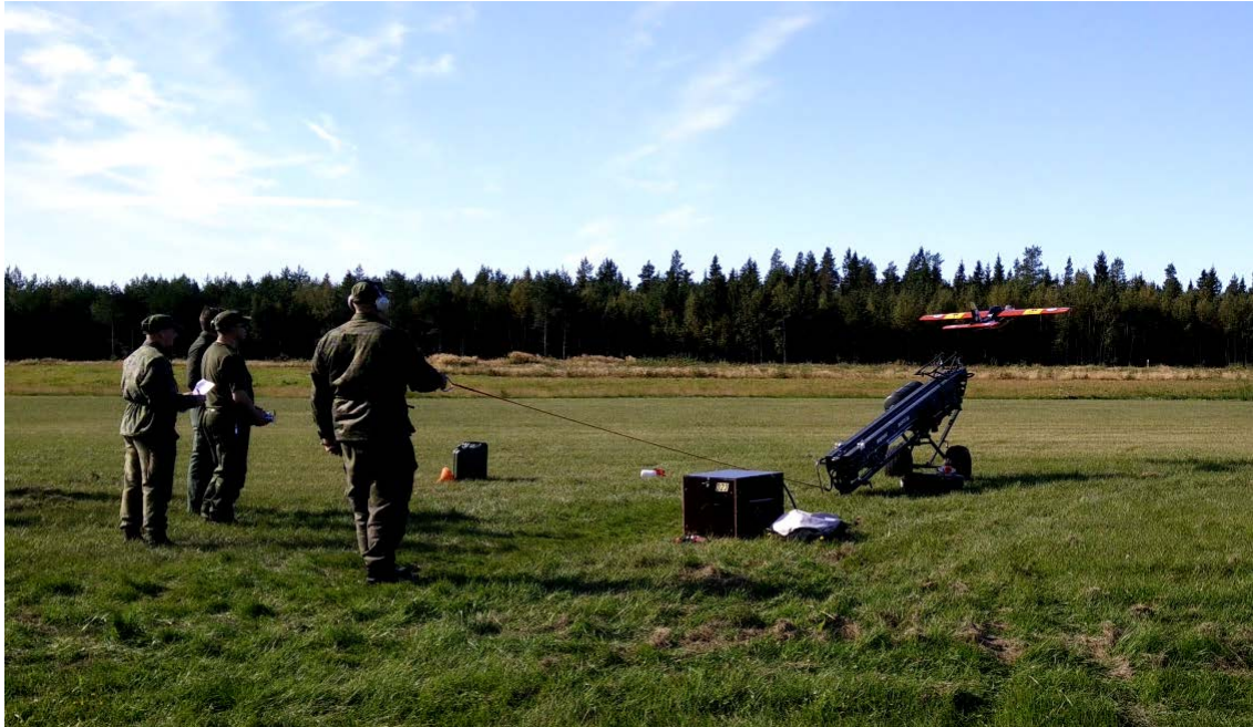
Kuva 21. Maalilennokin langattoman tiedonkeruujärjestelmän testausta Lohtajalla.
