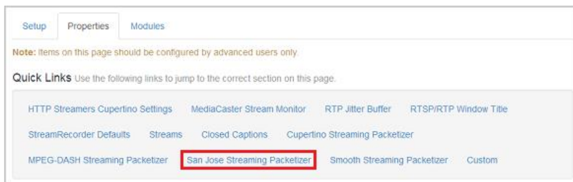
Kuva 47. Wowza Streaming Enginen konfiguraatiotiedoissa Adobe HDS -protokollaan viitataan nimellä "San Jose". Adobe HDS -protokollan käyttöönottoa kutsutaan San Jose -streamin konfiguroimiseksi [54; 55].
