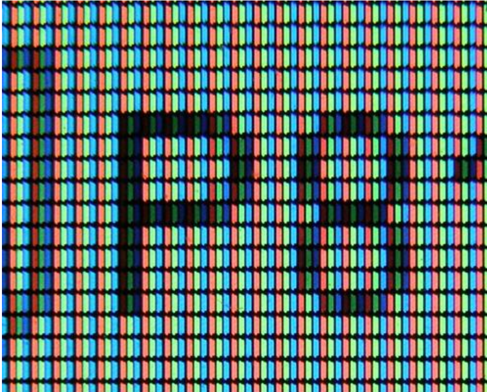
Kuva 32. LCD-näytön (Liquid Chrystal Display) RGB-pikselit läheltä kuvattuna [36].
