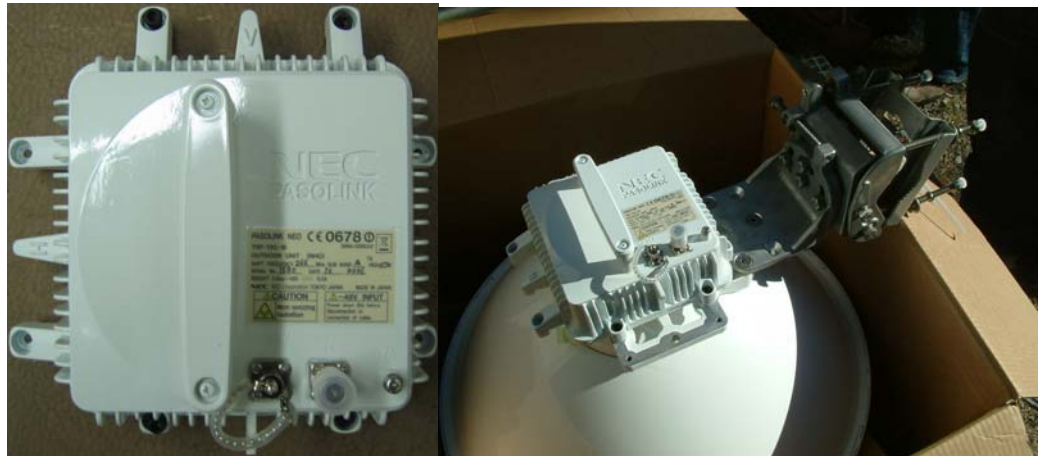
Kuva 21 Vasemmalla Pasolink NEO -radiolinkin ulkoyksikkö ja oikealla integroitu antenni ja ulkoyksikkö
