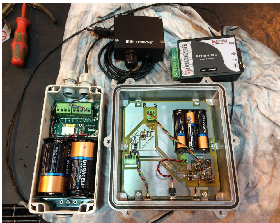
Kuva 25. Langattoman tiedonsiirron 0-10 VDC lähetinosa, usb-liitäntäinen tukiasema ja RMS-konverterri.
