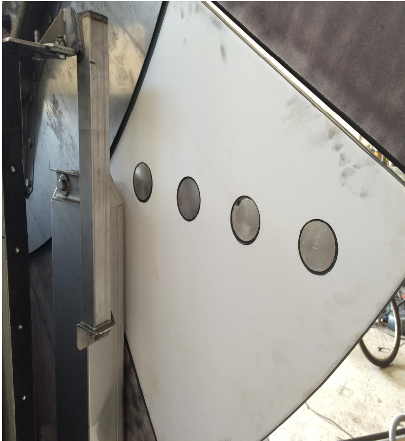
Kuva 22. Anturilaatta asennettuna testilaitteeseen, ultraäänivärähtelijä kuvassa vasemmalla.
