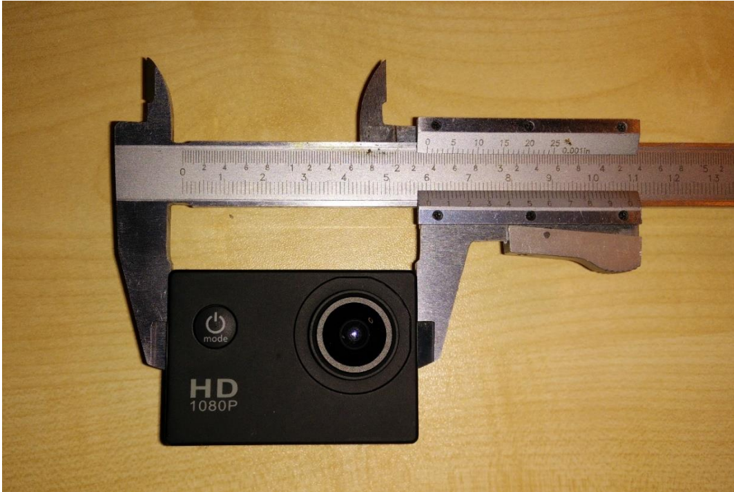
KUVA 1. Kappaleen mittaus työntömitalla
