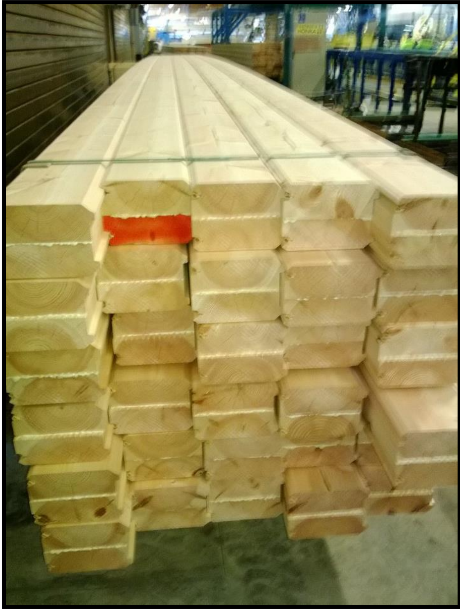
Kuvio 79. Jättilinjalla hirret niputetaan suoraan pakettiin.
