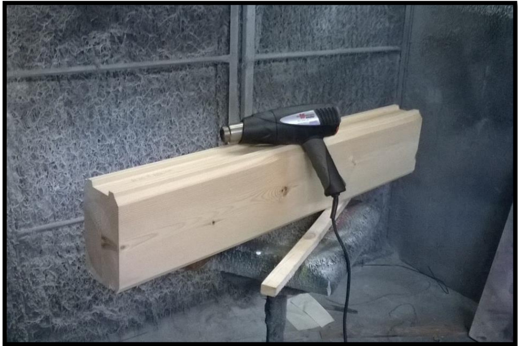
Kuvio 33. Hirren kuivauksen testaus tapahtui kuumailmapuhaltimella.
