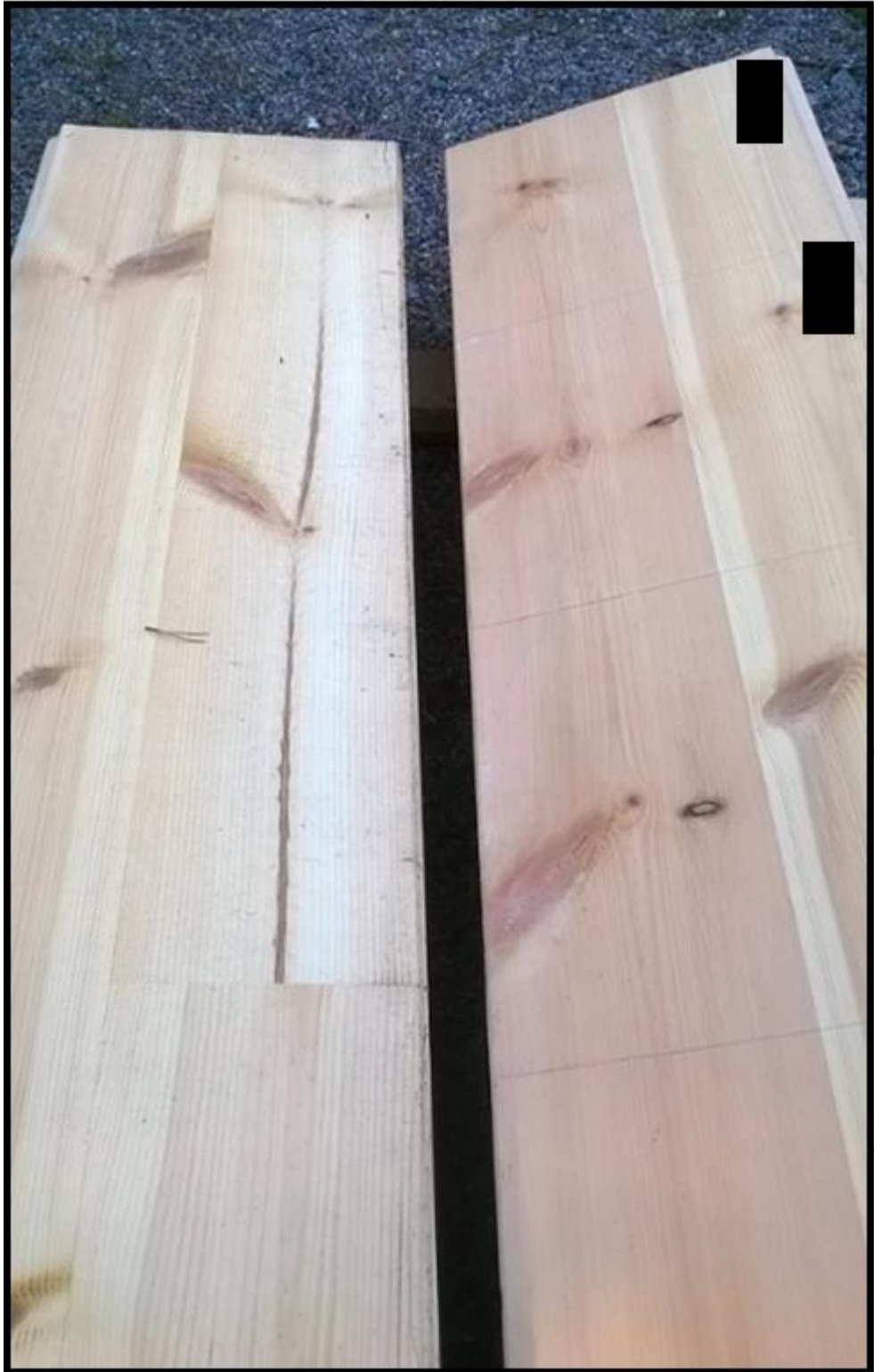
Kuvio 72. Hirsien kyljet kuukauden kuluttua, käsitelty kappale oikealla, siinä on punertavuutta.
