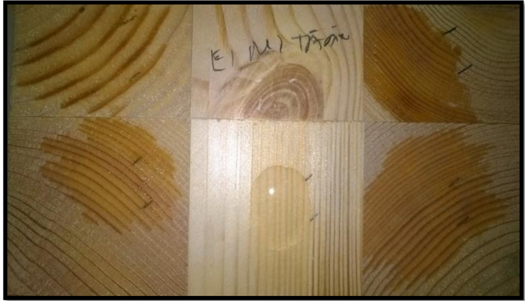
Kuvio 28. Vesi on imeytynyt käsittämättömään puuhun kokonaan. Käsittämätön kohta ylhäällä keskellä.
