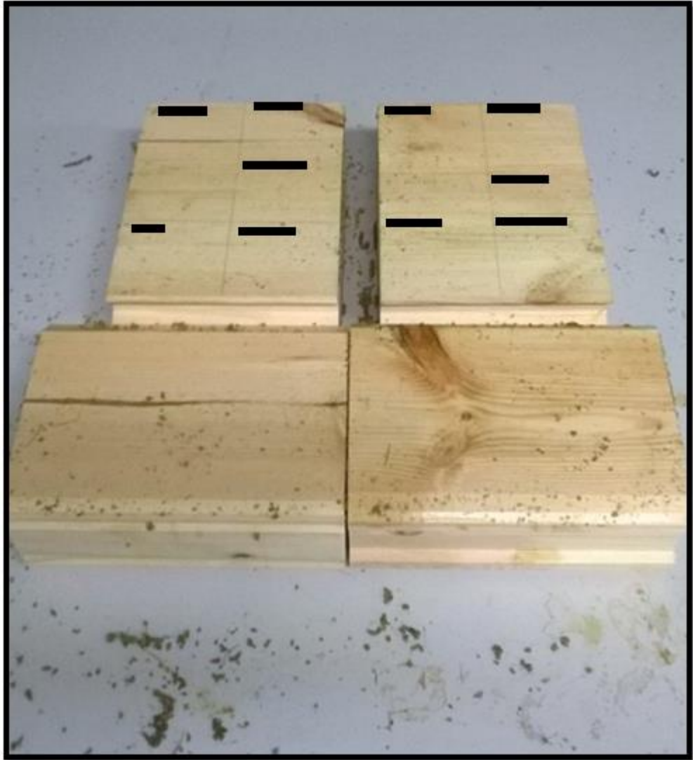
Kuvio 49. Testikappaleissa on ollut siitepölyliuos noin 60 minuuttia.
