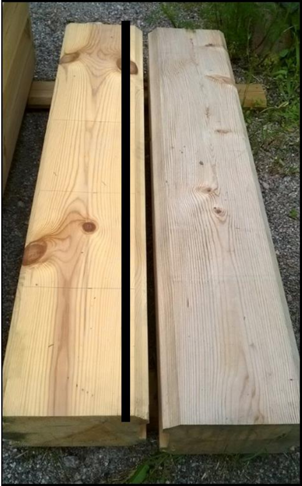
Kuvio 69. Hirret ovat olleet kentällä suorassa sateessa yhden kuukauden, käsitelty kappale vasemmalla.
