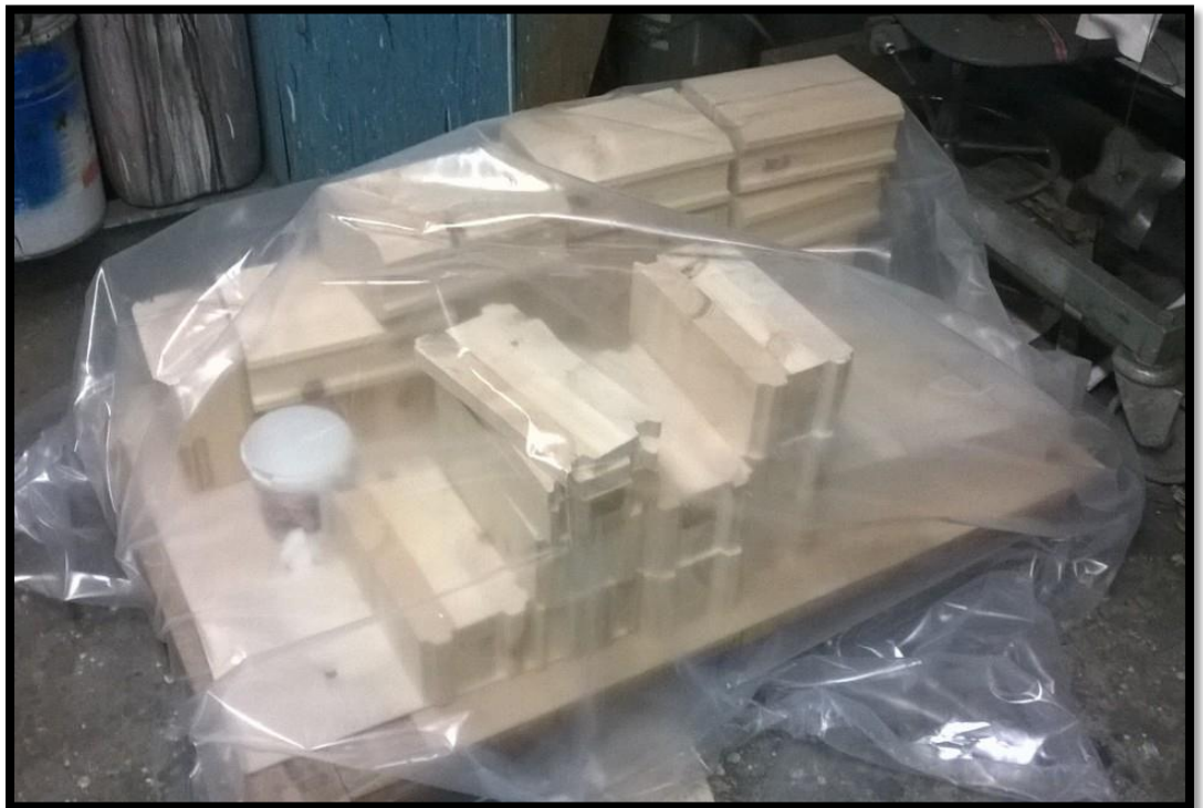
Kuvio 22. Hirsinäytteet säilytettiin muovien alla missä oli vesiastioita, jotta ne eivät halkeilisi ja kuivuisi.
