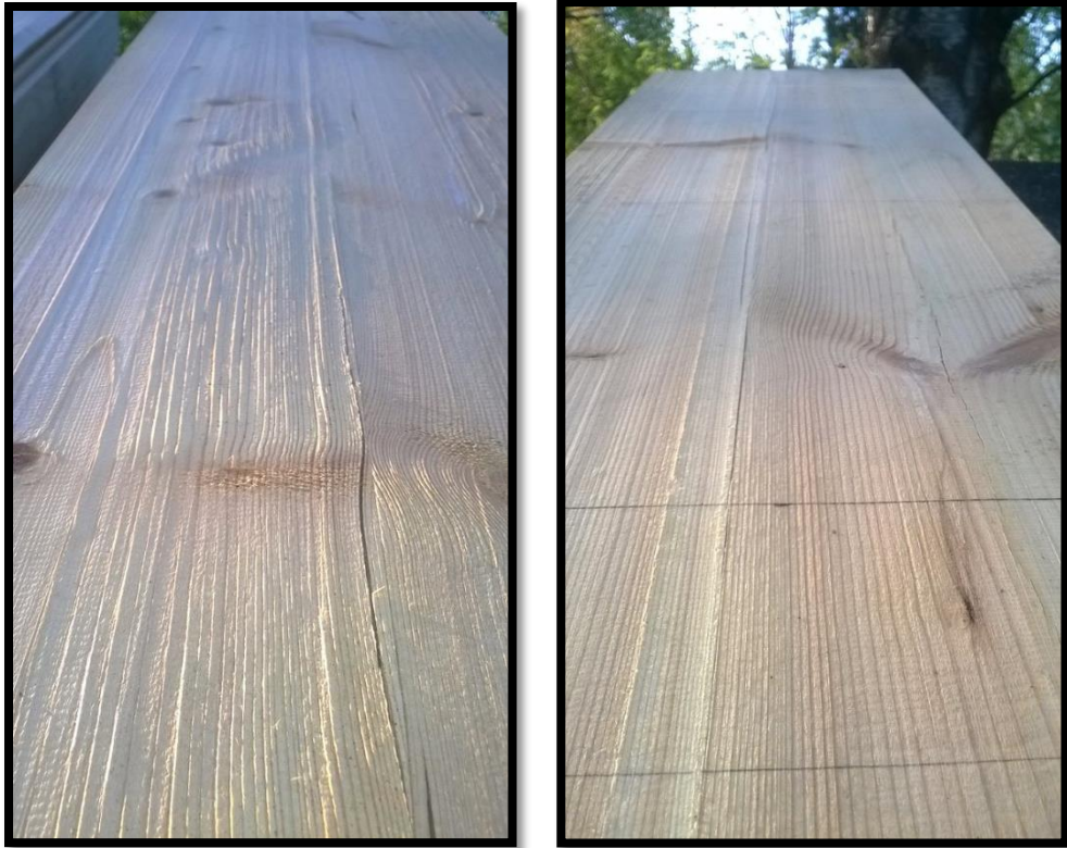
Kuvio 64. Lähikuva kaksi kuukautta kentällä olleista hirsistä. Oikealla käsitelty hirsi.
