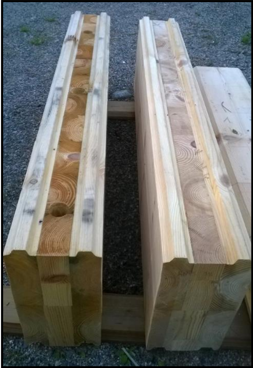
Kuvio 71. Hirret ovat olleet kentällä yhden kuukauden, käsitelty kappale oikealla.
