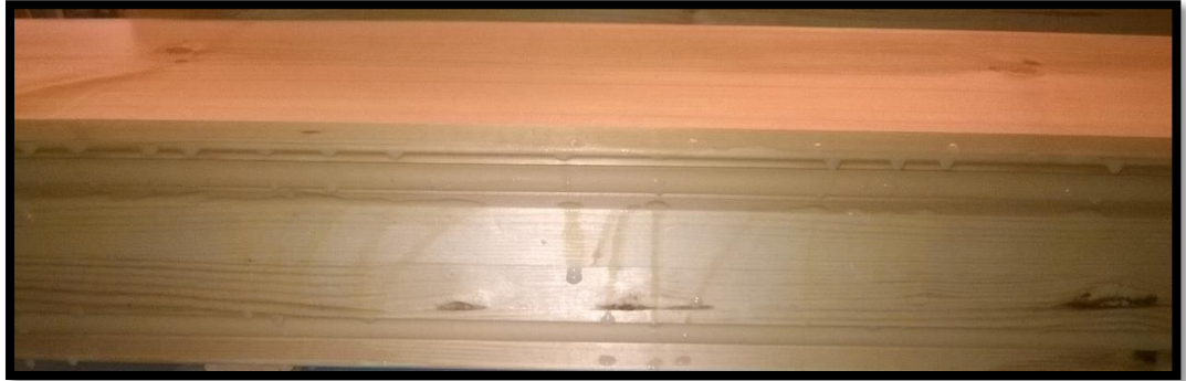
Kuvio 39. Aineen valumia telauksessa ja pensselillä levitettäessä
