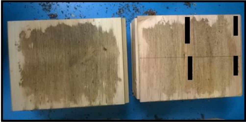
Kuvio 55. Kuivalla puhdistusliinalla pyyhityt kappaleet, oikealla hartsiliimalla käsitelty ja vasemmalla referenssikappale.
