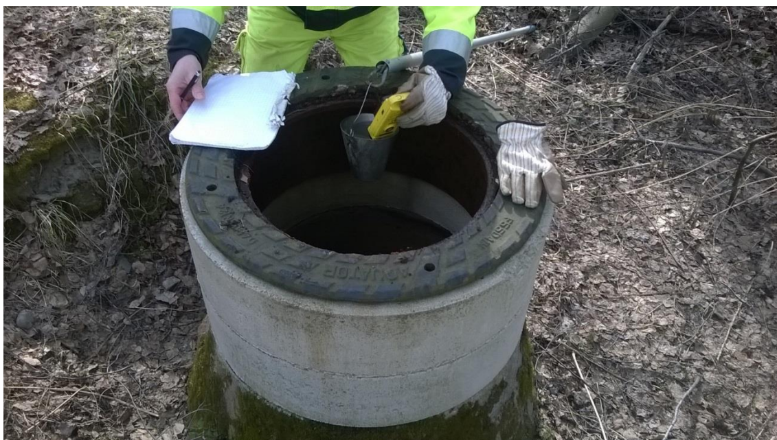
KUVA 8. Vuove-menetelmä, veden laadun tutkinta
