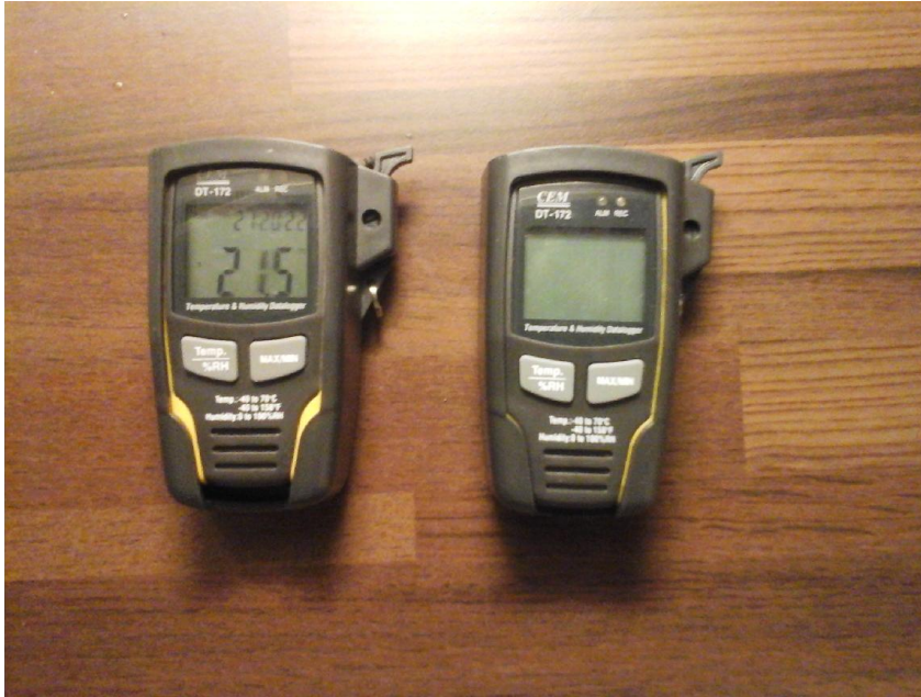
KUVA 23. CEM DT-172 – lämpötila ja kosteus-dataloggeri
