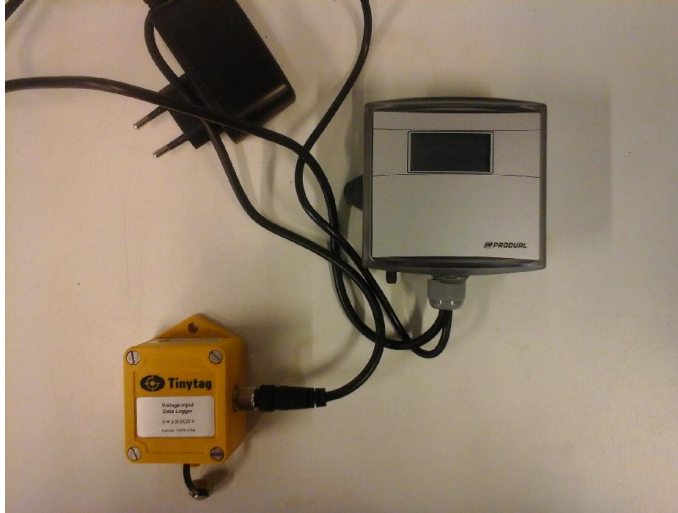
KUVA 20. Tinytag TGPR – 0704 – dataloggeri ja Produal PEL-N – paineanturi
