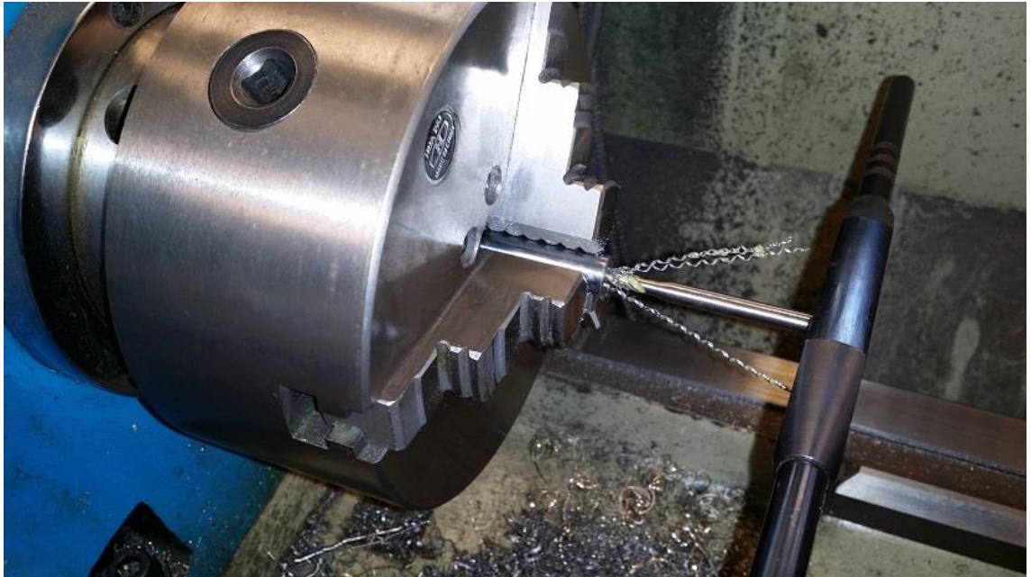
Kuva 36. Öljypumpun akselin pään kierteistämistä.
