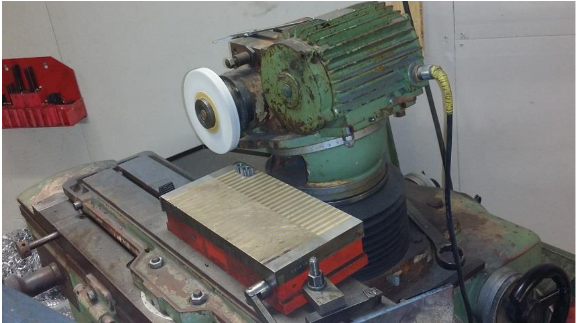
Kuva 31. Hammaspyörien sivujen hiontaa.
