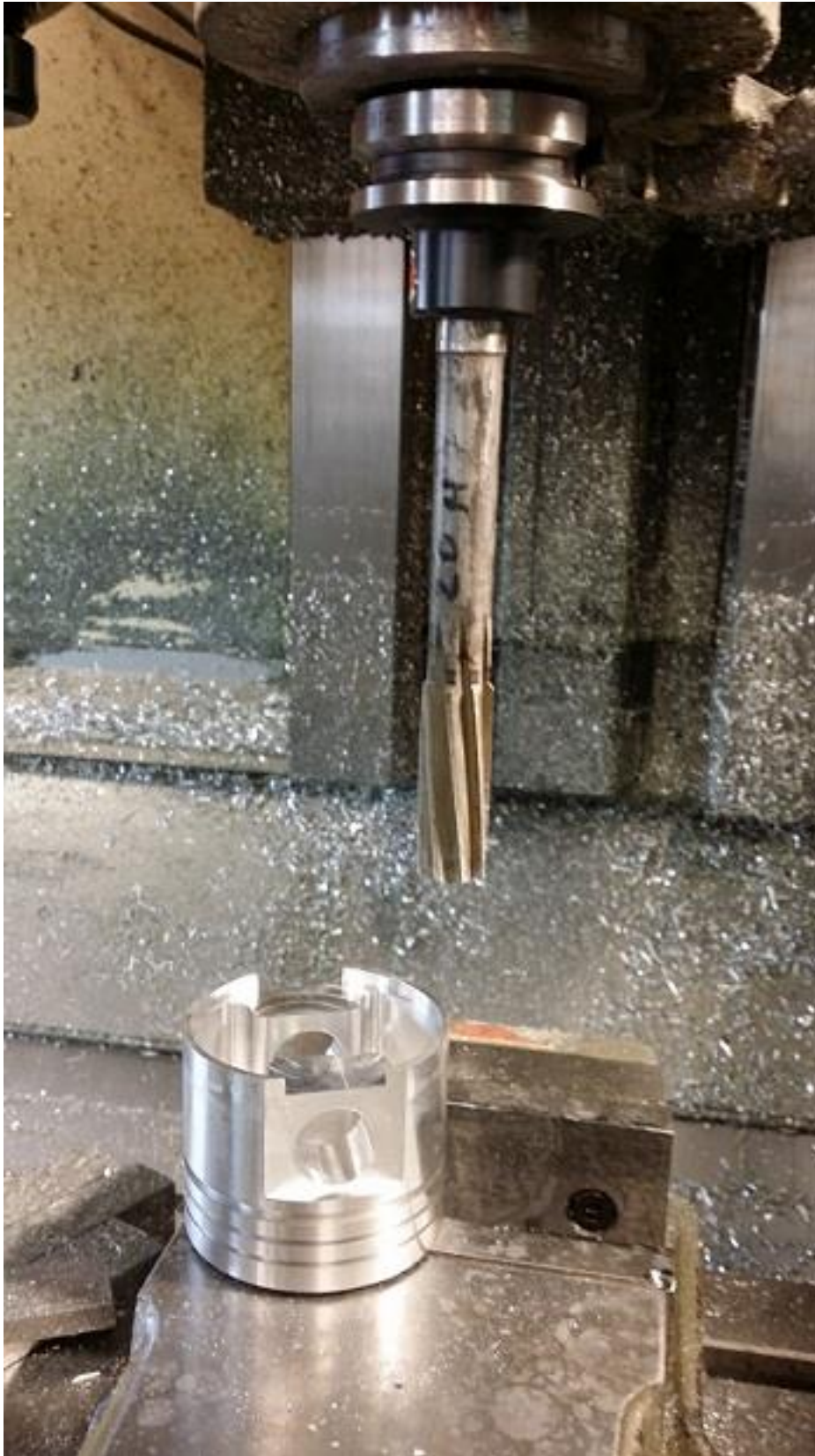
Kuva 21. Männän reiät valmiina.
