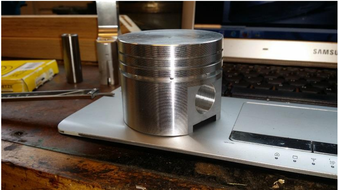
Kuva 22. Valmis mäntä sivusta.
