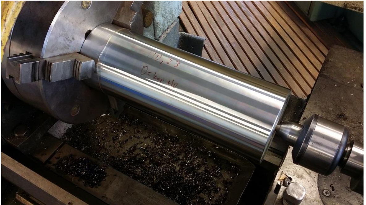
Kuva 4. Kampiakselin ulkomitta sorvattuna.
