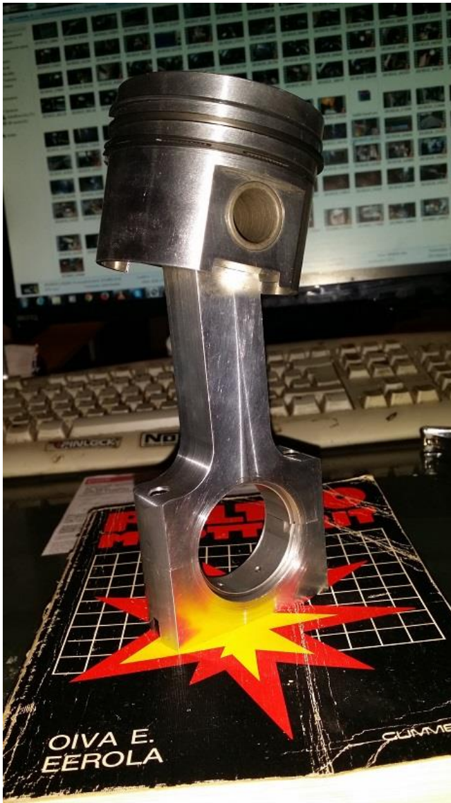
Kuva 41. Mäntä ja kiertokanki heloineen ja liuskoineen.
