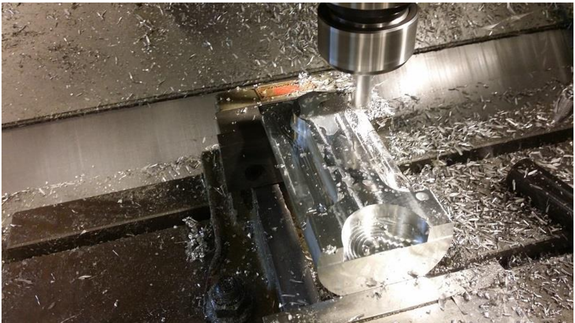
Kuva 26. Kiertokangen ulkomuodon jyrsintää.
