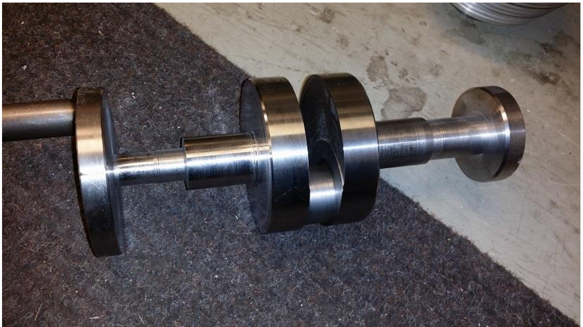
Kuva 6. Kampiakseli valmiina hehkutukseen.
