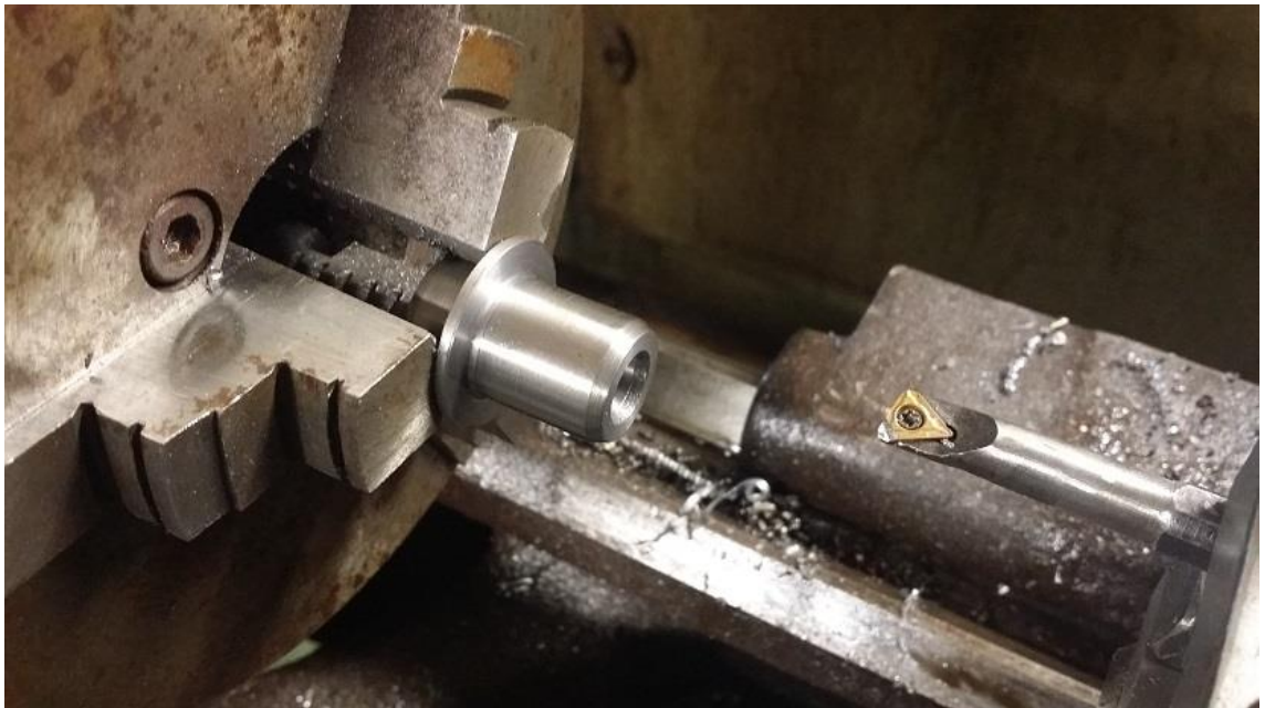
Kuva 13. Ohjainosan sisäsorvausta muokatulla terävarrella.
