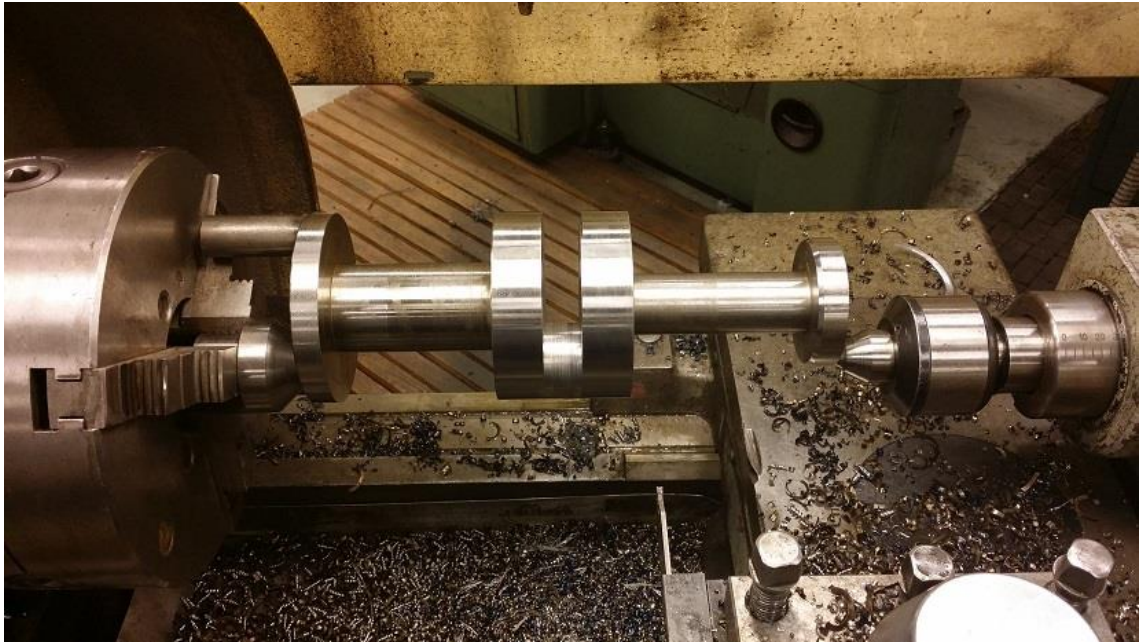
Kuva 5. Kammenpolven sorvaus aloitettu
