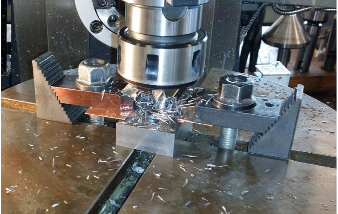
Kuva 33. Öljypumpun rungon jysintää.
