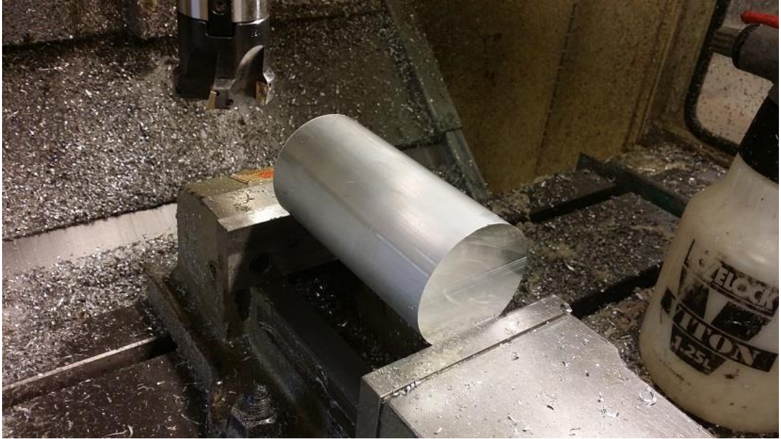
Kuva 25. Kiertokangen aihio jyrsinkoneessa.
