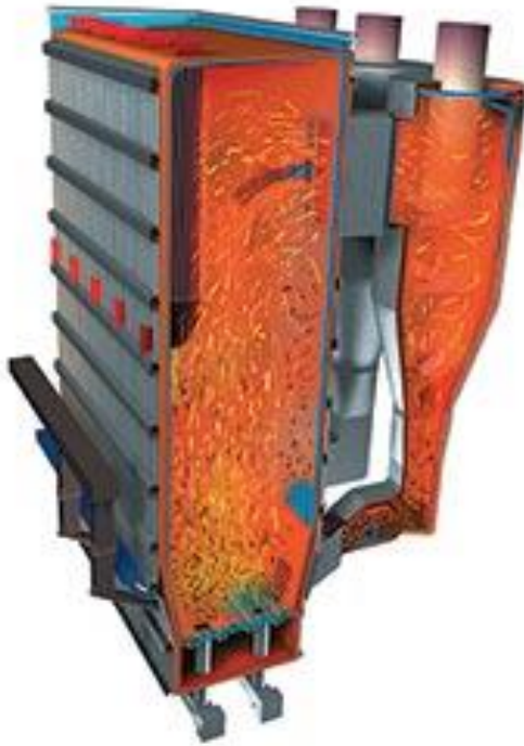
Kuva 9. Kiertoleijukattilan tulipesä ja syklonit (Valmet, CFB-kattilat).
