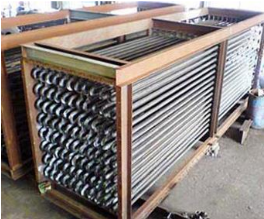
Kuva 5. Syöttöveden esilämmittimen putkipaketti rivoittamattomilla putkilla.
