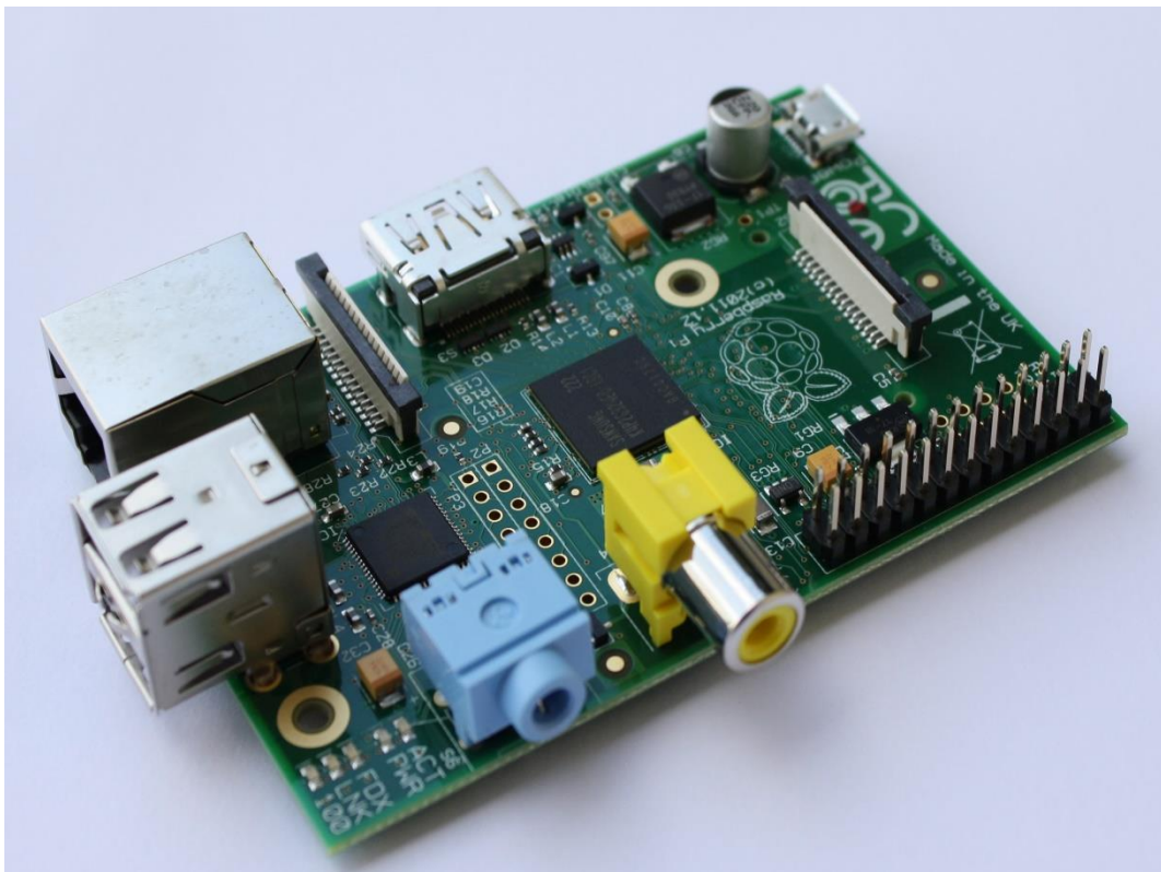
Kuva 4. Raspberry Pi Model B versio, joka on tunnistettavissa 26 GPIO pinnistä ja kahdesta USB-portista.
