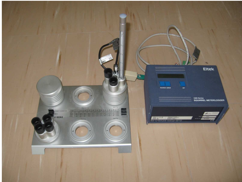
Kuva 4.2. Dataloggerin kalibrointi Vaisalan HMK15 kosteuskalibraattorilla
