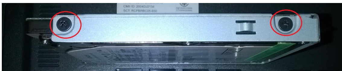
Kiintolevyn irrottaminen kehikosta.
