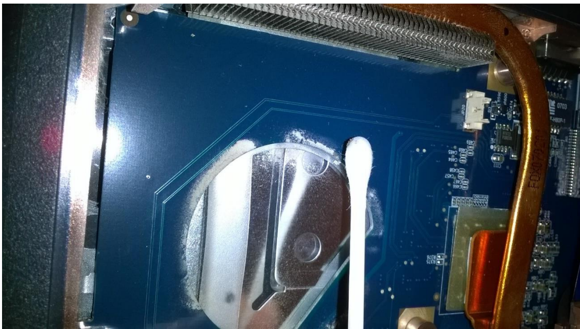
Vanupuikoilla ja isopropyylialkoholilla puhdistaminen.
