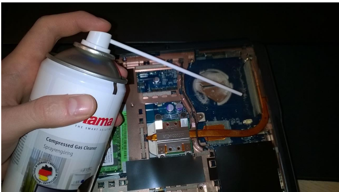
Paineilmalla jäähdytysriipojen puhdistus.
