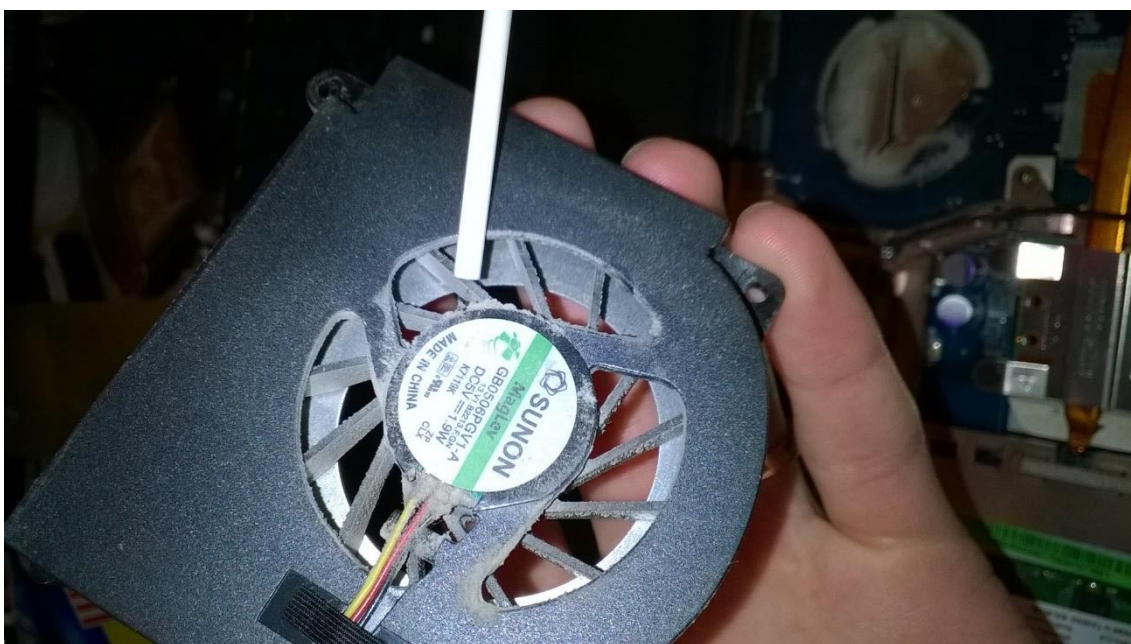
Paineilmalla tuulettimen puhdistaminen.
