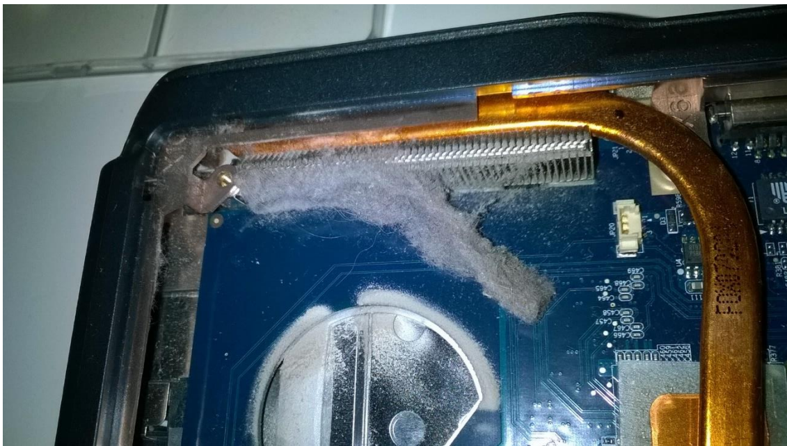
Tuulettimen ja jäähdytysripojen välissä oleva pölykertymä.
