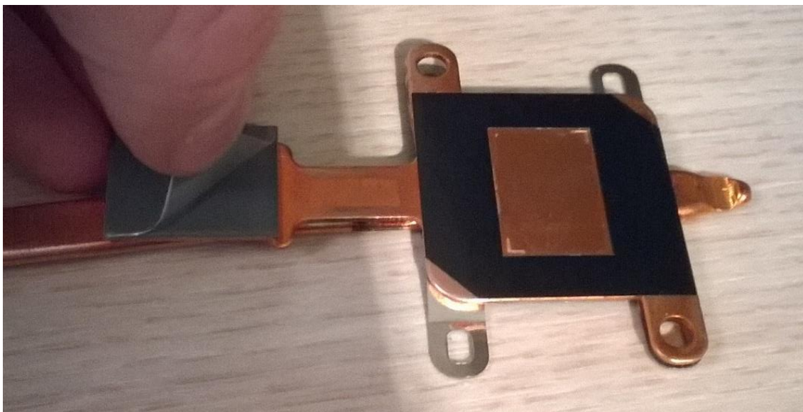
Uuden lämpötyynyn asettaminen.
