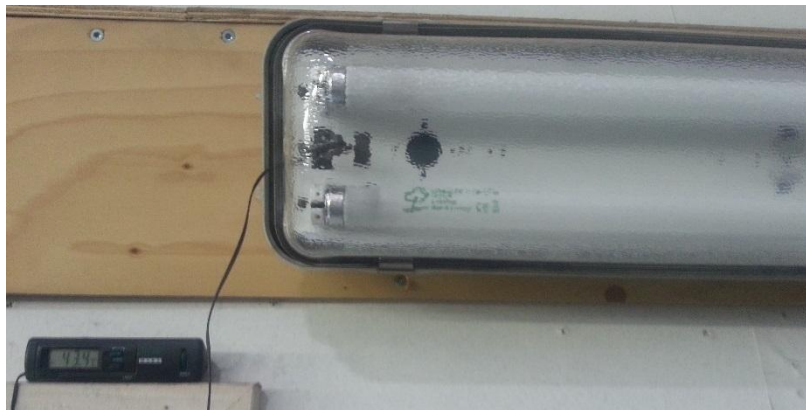
Kuva 11. Loisteputkivalaisimen kotelon sisälämpötila oli 43,4 °C tunnin polttoajan jälkeen (Lotvonen, 2015).
